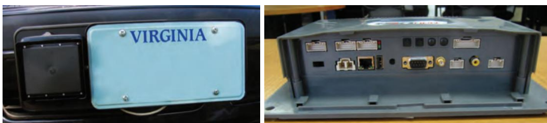
Abb. 5.2 Front-Radarsensor am Kennzeichenhalter (links), Fahrzeugintegrierte Datenaufzeichnungseinheit (rechts) [112]
