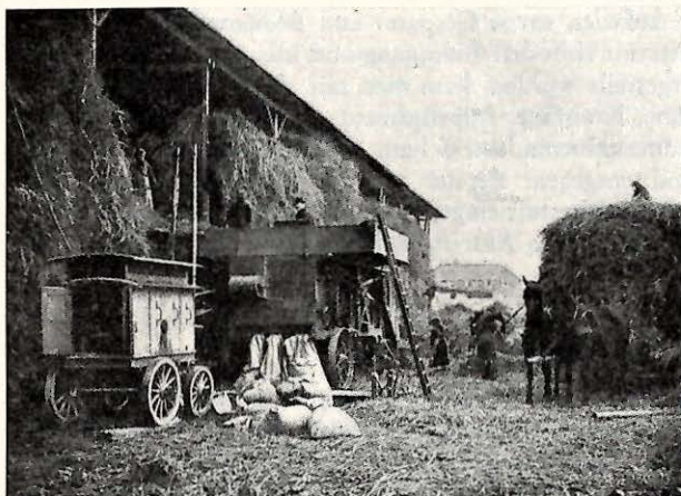
Abb. 3: Elektrisches Dreschen an der Feldscheune
