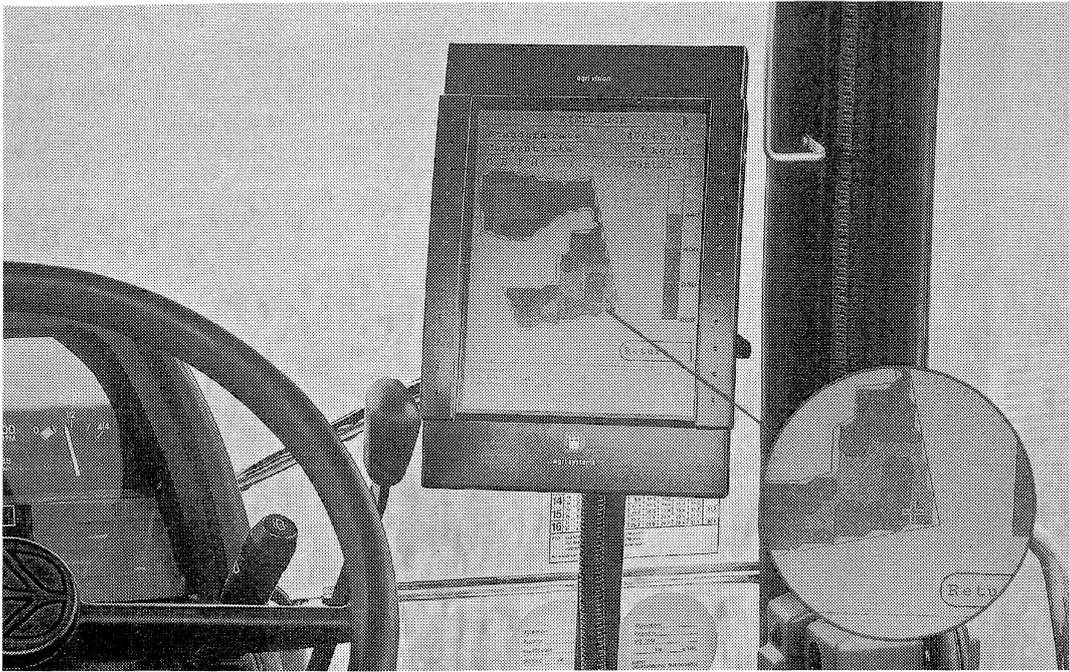
Mit Hilfe von GPS weiß der Fahrer exakt, wo er sich gerade auf dem Feld befindet. Der Bordcomputer kann die Daten von Ertrags- und Applikationskarten für die Gerätesteuerung umsetzen. **Werkbild: AGCO**
