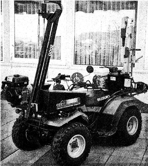
GPS kann auf Leichtfahrzeugen zur Schlagvermessung oder zum Ziehen von positionierten Bodenproben eingesetzt werden. Foto: Neub
