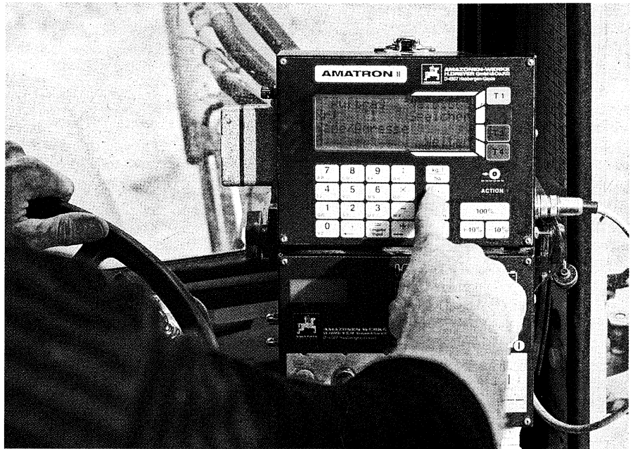
Anhand der Kippschalter läßt sich beim Amatron (baugleich mit dem Uni Control von Müller Elektronik) die Schalterstellung ohne Blickkontakt erkennen.
