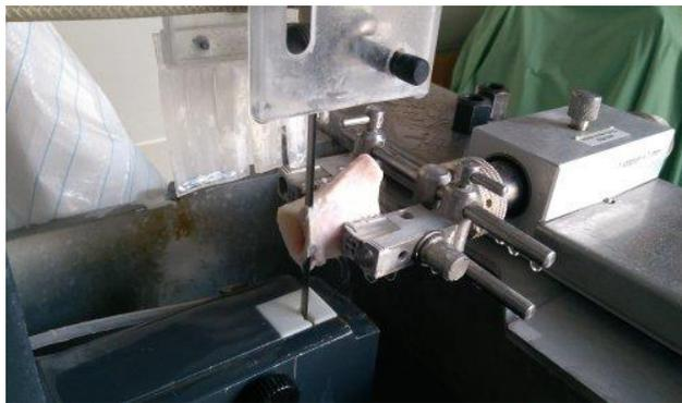
Abbildung 15: EXACT 300 Bandsäge mit Knochen
