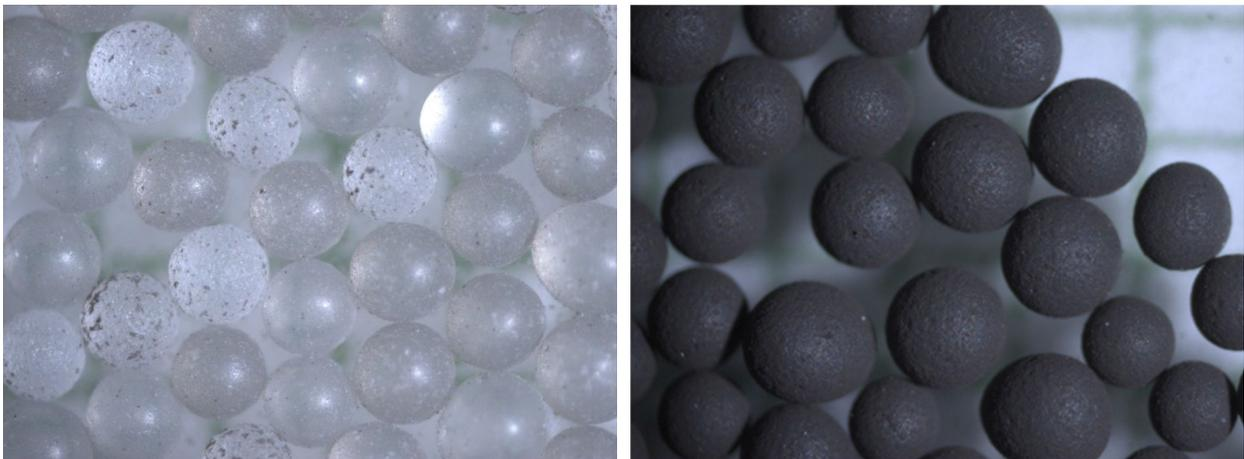
**Abbildung 5: Vorkonditionierte Glaskugeln (a, links) und  $\text{MnO}_x$ -78-Kugelkollektoren (b, rechts) in jeweils 25-facher Vergrößerung**
