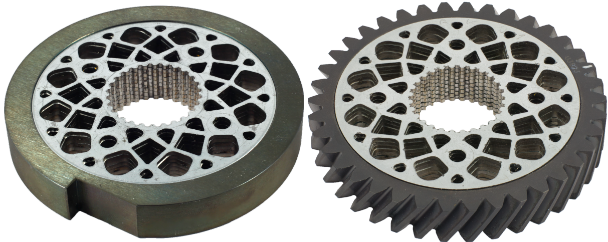
Abbildung 7.16: Testrad mit blechpaketierten Leichtbauradkörper (links); Zahnrad mit blechpaketiertem Leichtbauradkörper (rechts)
