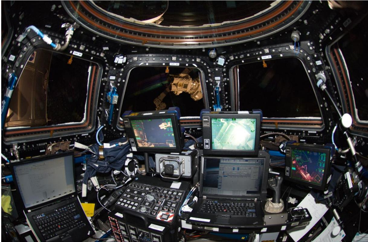
Abb. 1–3: Robotics Workstation des SSRMS im Kuppelmodul [13]
