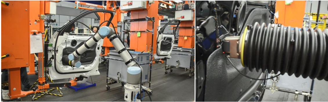
Abbildung 5-4: MRI-Anrollprozess mit dem Leichtbaurobotersystem Universal Robots UR10 im BMW Group Werk Spartanburg
