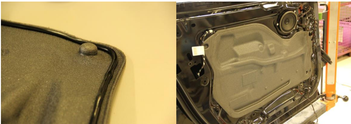
Abbildung 5-1: Schallisolierung für die akustische Isolierung und Abdichtung des Türinnenraumes zum Fahrgastinnenraum des BMW X3
