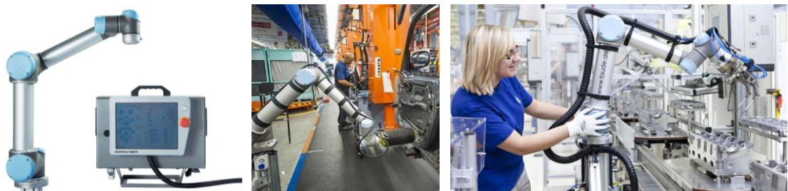
Abbildung 2-8: Roboter der Firma Universal Robots, UR 5 (links) [81], Einsatz eines UR 10 im BMW Group Werk Spartanburg (mitte) [17], Einsatz eines UR5 im VW Motoren Werk Salzgitter [83]
