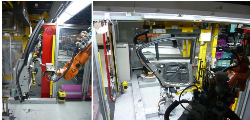
Abbildung 5-3: Vollautomatisierte Lösungsvariante zum Anrollen der Schallisolierung im BMW Group Werk München für die Tür der BMW 3er Serie
