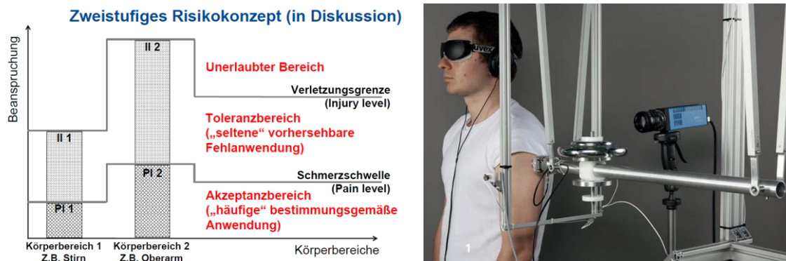
Abbildung 2-18: Zweistufiges Risikokzept des IFA im Hinblick auf mögliche Grenzwerte, rechts Versuchsaufbau des Fraunhofer IFF zur experimentellen Ermittlung von Grenzwerten [29; 108]
