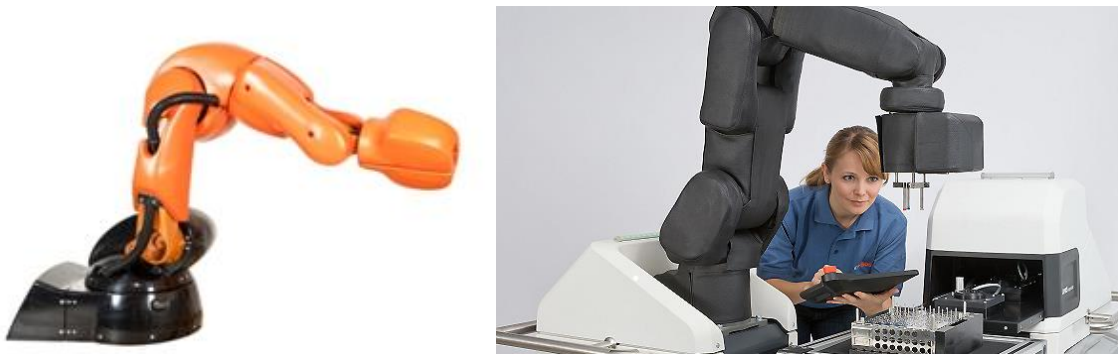
Abbildung 2-6: Beispielhafte Darstellung von Robotersystemen mit taktilen Schutzhäuten, KR5 Si der Firma MRK Systeme (rechts) [73], Robotersystem der Firma Bosch „APAS“ (links) [74]
