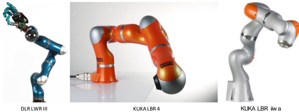
Abbildung 2-7: Weiterentwicklung des DLR Leichtbauroboters, DLR LWR III (links 2003), KUKA LBR 4 (mitte, 2008), KUKA LBR 4+ (2010, nicht gezeigt), KUKA LBR iiwa 14 (rechts, 2013)
