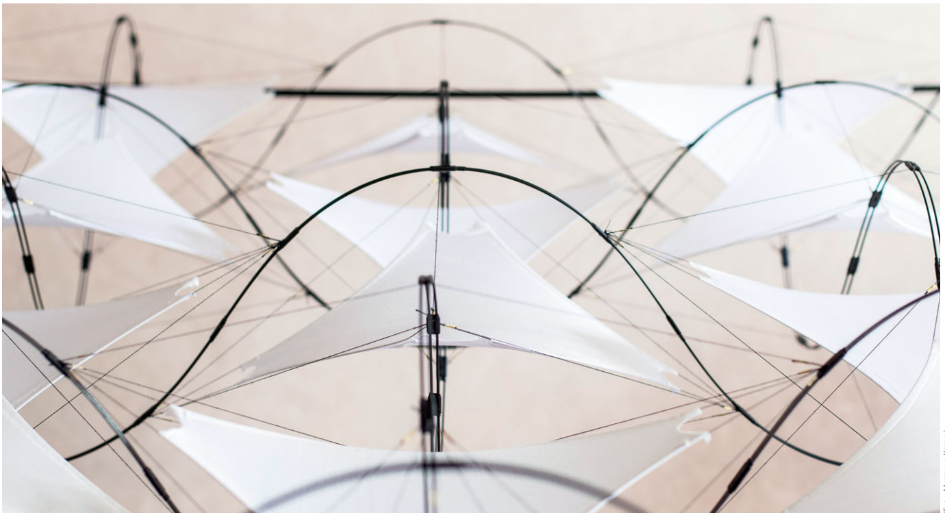
Bild 4 Tensegritystruktur aus gebogenem Federstahl, Seilen und Membranen von SEBASTIAN HUTH Tensegrity structure made of bend steel wire, cables and membranes by SEBASTIAN HUTH
