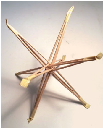
Bild 5 Räumliches Scherenmodul aus vier Stabgruppen mit jeweils drei Stäben Spatial scissor module made out of four groups of sticks
