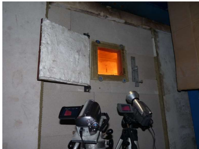
Abb. 7-11: Beobachtungsfenster des kleinen Deckenofens der MFPA Leipzig GmbH mit zwei Videokameras zur Beobachtung des Schädigungsverhaltens.
