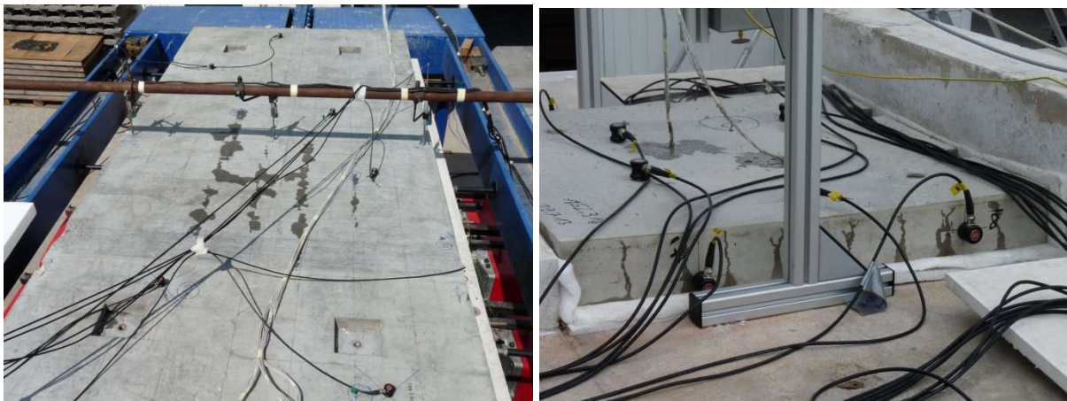
Abb. 7-17: Auf der Oberseite der Testkörper tritt während der Brandprüfung Wasser aus. Zu sehen sind die Experimente P-ZTV-70-0,9PP (links) und Qk-RWS-70 (rechts).
