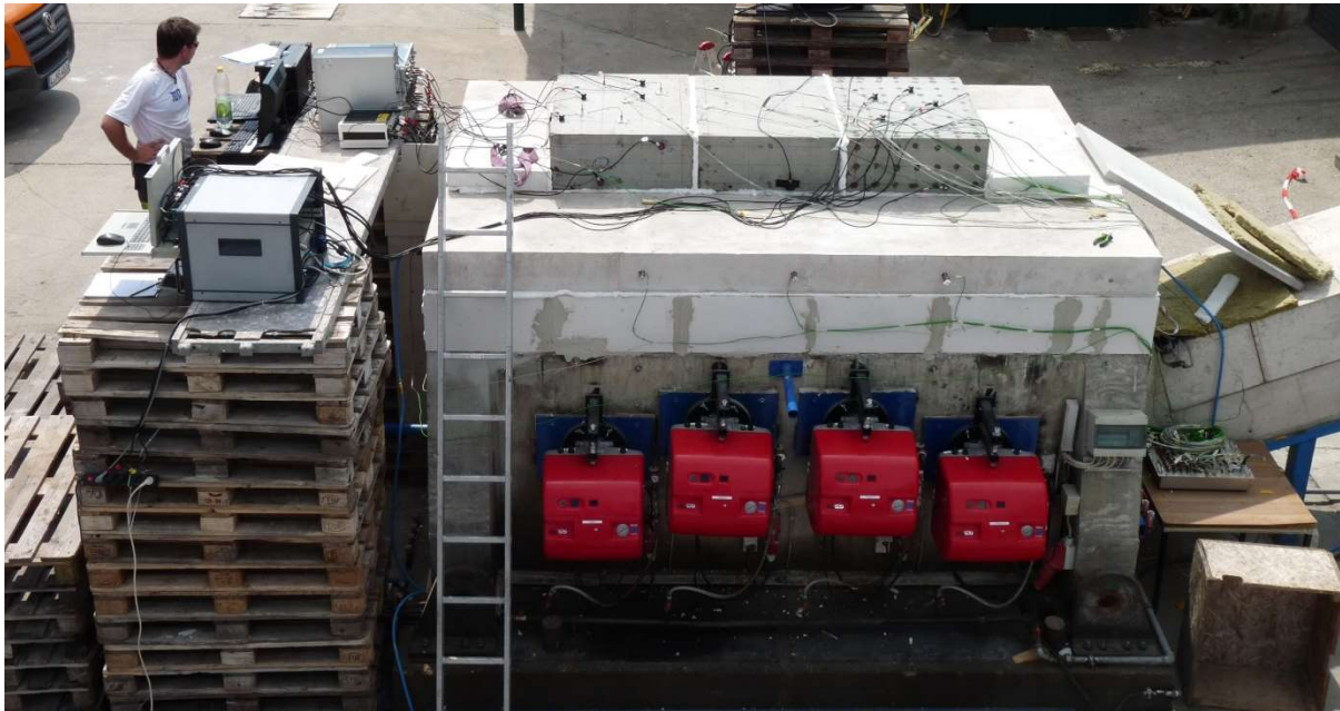
Abb. 5-4: Großer Tunnelofen der MFPA Leipzig GmbH mit je vier Ölbrennern an zwei Seiten. Aufgelegt sind drei Testkörper, die beiden äußeren sind mit Schallemissionssensoren bestückt. Die Transientenrekorder sind auf der linken Seite so nah wie möglich am Ofen platziert.
