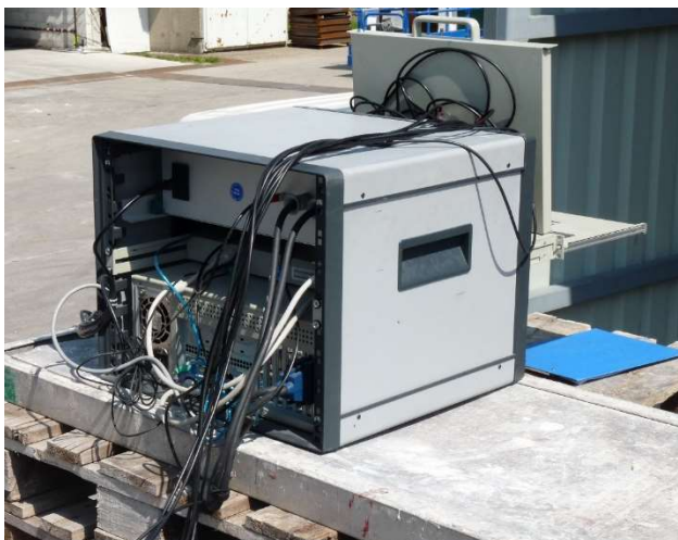
Abb. 3-11: Transientenrekorder TransOcto AE (TO) mit eingebauten SmartPre Dig -Vorverstärkern.
