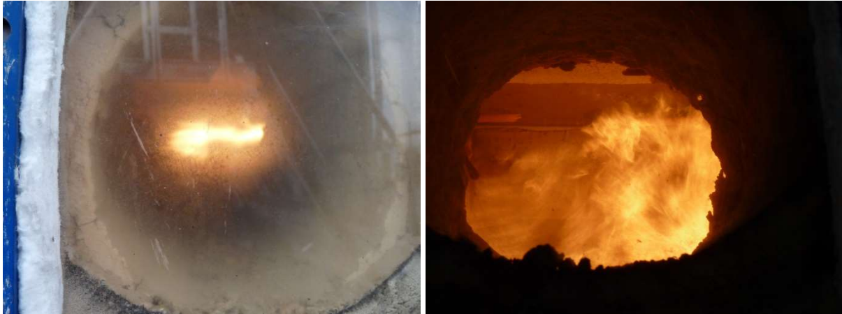
Abb. 7-12: Beobachtungsfenster der Brandöfen mit eingeschränkter Sicht während des Versuchs. Links mit angelaufener Scheibe und Rauch im Ofen, rechts verhindern Flammen eine komplette Sicht auf den Testkörper.
