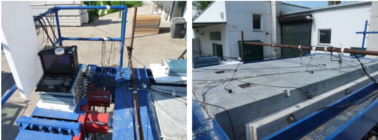
Abb. 5-12: Auf dem Belastungsrahmen installierter Transientenrekorder mit Vorverstärkern (links) und auf die Betonplatte aufgeklebte Schallemissionssensoren (rechts).
