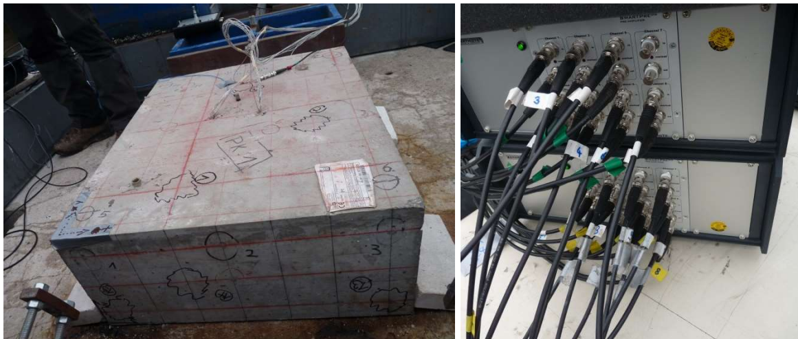
Abb. 6-3: Testkörper mit aufgezeichnetem Messraster, Testkörpernummerierung und Koordinatensystem. Die Sensorpositionen und Nummerierungen sind durch Kreise um die Kreuzungspunkte des Rasters markiert.
