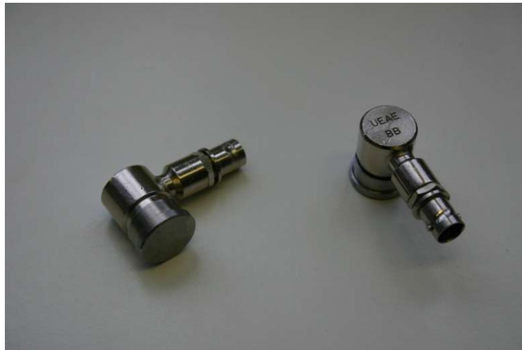
Abb. 3-6: Schallemissionssensor UEAE der Firma Geotron.
