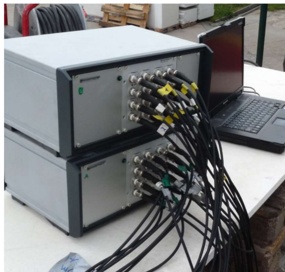
Abb. 3-9: Die beiden SmartPre Dig -Vorverstärker mit je acht Kanälen.
