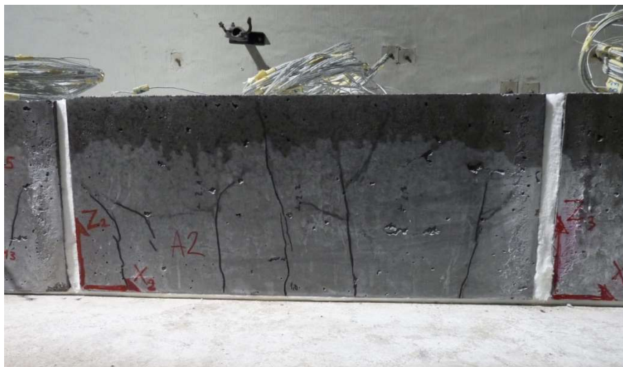
Abb. 7-18: Austrocknung im unteren Bereich der Testkörper, hier bei Q-ETK-120-1PP.
