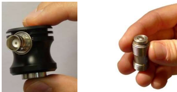
Abb. 3-3: Breitbandige Schallemissionssensoren: Panametrics V103 (Links) und Glaser-type (Rechts).
