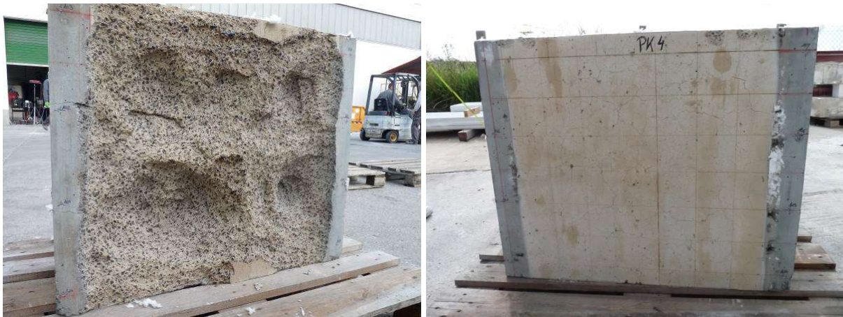
Abb. 7-19: Direkter Vergleich der Testkörper von Q-ZTV-90-0PP mit Abplatzungen (links) und Q-ZTV-80-1PP (rechts) nach der Brandprüfung.
