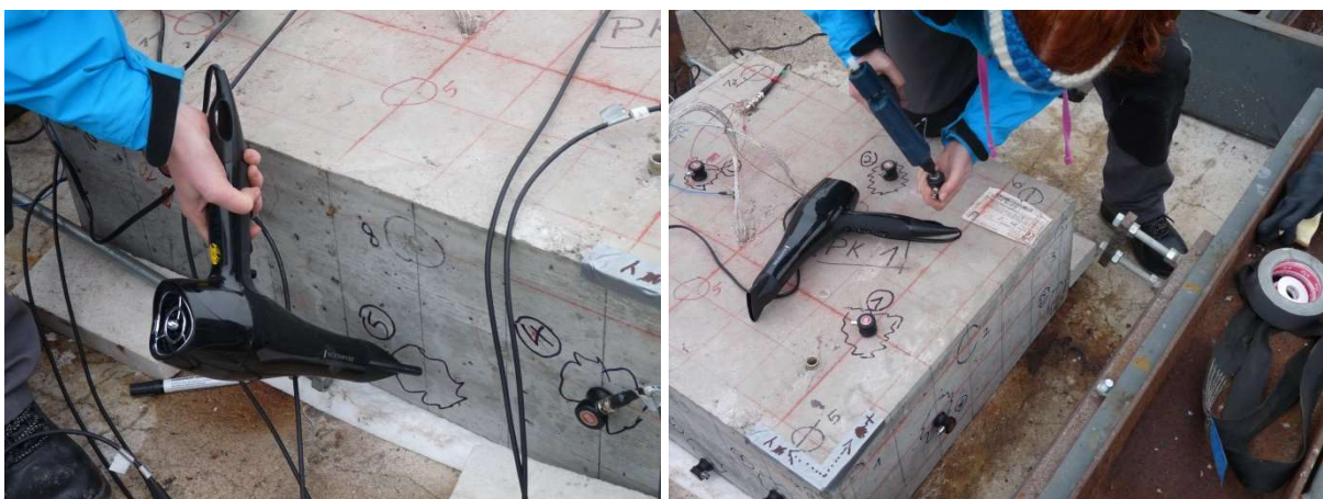
Abb. 6-8: Vorwärmen der Betonoberfläche mit einem Haarföhn und anschließende Befestigung der Sensoren mit Heißkleber.
