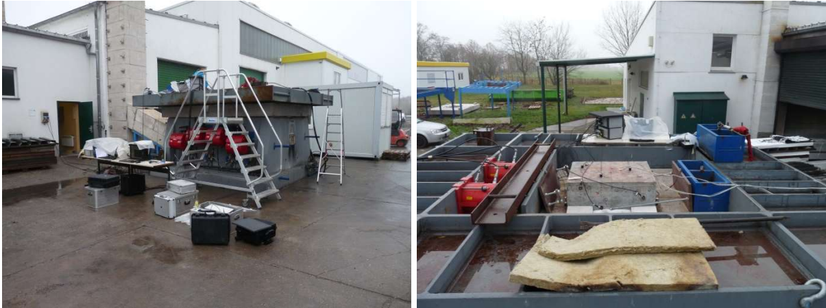
Abb. 5-8: Prüfung von einzelnen Quadern auf dem großen Tunnelbrandofen der MFPA Leipzig GmbH.
