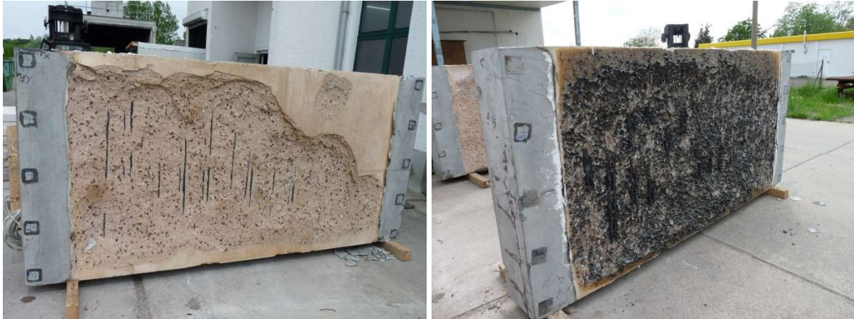
Abb. 7-22: Vergleich der Betonverfärbung bei unterschiedlichen Brandkurven P-ZTV-70-0,9PP (links) und P-RWS-70-0,9PP (rechts).
