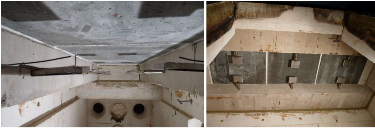
Abb. 5-2: Blick ins Innere des Ofens. Zu sehen ist die Unterseite der Testkörper, die während des Versuchs beflammt wurden, die beiden Öffnungen für die Ölbrenner (links) und ein Teil der Temperaturmessstellen.
