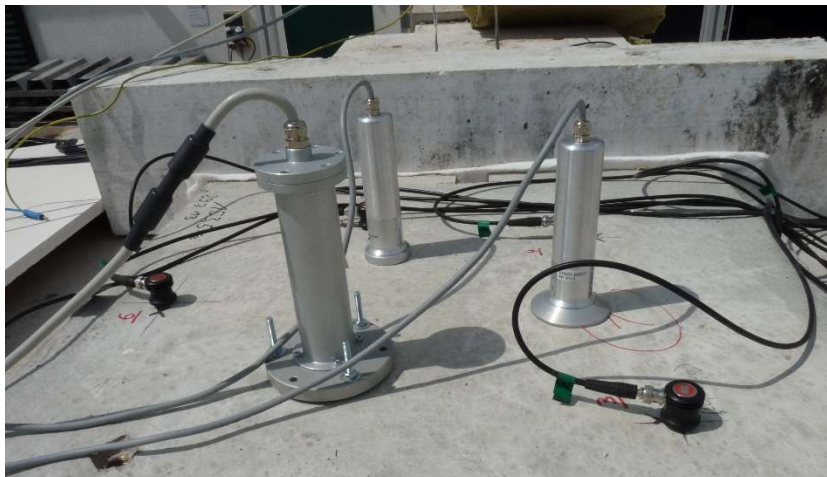
Abb. 3-20: Sensoren zur Mikrowellen-Feuchtemessung auf dem Testkörper, während des Brandexperimentes Qk-RWS-70-1,5PP und Qk-RWS-70-2PP.
