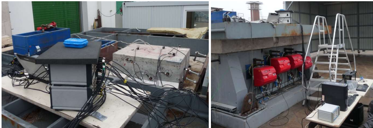
Abb. 6-2: Testkörper mit den Vorverstärkern und zugehörigem Laptop am Rand des Belastungsrahmens (links). Die Transientenrekorder sind auf Tischen mit Abstand zum Brandprüfofen positioniert. Als Aufstiegshilfe dient eine fahrbare Treppe (rechts).
