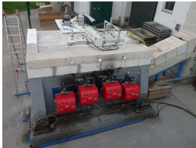
Abb. 5-6: Großer Tunnelbrandofen der MFPA Leipzig GmbH, umgebaut für die Prüfung von zwei Quadern mit 10 cm Dicke (Qk).
