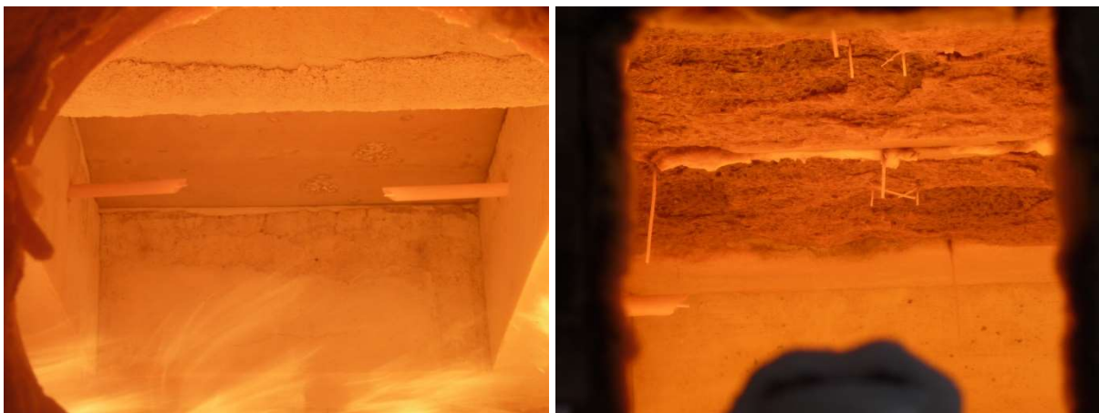
Abb. 7-13: Beobachtungsfenster mit ungehindertem Blick auf die Abplatzungen der Betonoberfläche.
