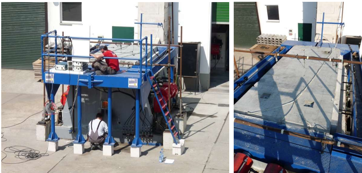
Abb. 5-10: Großer Tunnelbrandofen der MFPA Leipzig GmbH mit einem plattenförmigen Testkörper, der in einen Belastungsrahmen eingespannt wurde.
