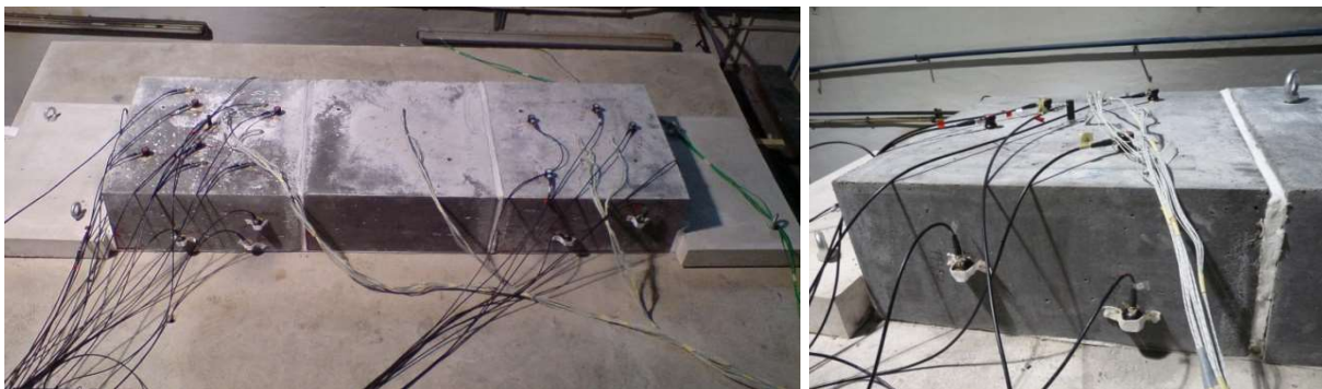
Abb. 5-3: Nebeneinander angeordnete Testkörper. Auf der Oberseite der beiden äußeren Testkörper wurden Schallemissionssensoren angebracht.
