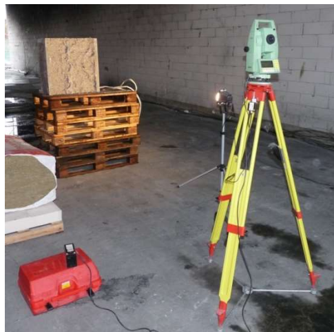
Abb. 3-19: Abplatztiefenbestimmung mit einem Lasertachymeter [Juknat 2014]
