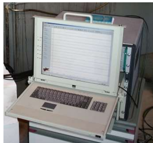
Abb. 3-11: Transientenrekorder TransOcto AE (TO) mit eingebauten SmartPre Dig -Vorverstärkern.
