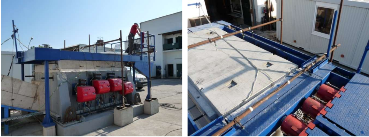
Abb. 5-11: Seitenansicht des Belastungsrahmens und des Prüfofens mit vier Ölbrennern auf jeder Seite (links). Hydraulikstempel des Belastungsrahmens zur Steuerung der horizontalen Belastung (rechts).
