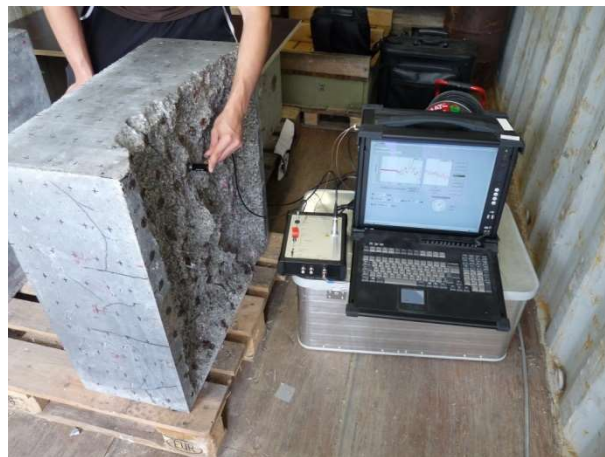
Abb. 11-4: Messung der Ultraschallgeschwindigkeit im Testkörper in Durchschallung.
