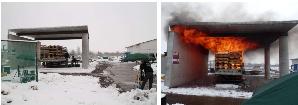
Abb. 5-13: Brückenbrandprüfstand vor dem Realbrandversuch (links) und während des LKW-Vollbrandes (rechts). Der Brandversuch wurde aus verschiedenen Positionen heraus mit Video- und Thermographiekameras dokumentiert.
