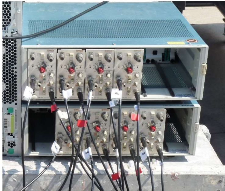
Abb. 3-8: Vorverstärker Tektronix AM 502 mit acht Messkanälen.
