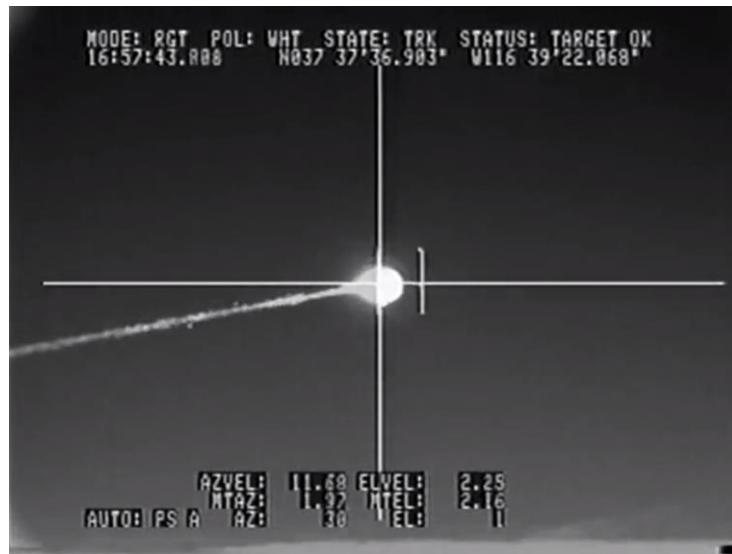
Abb. 1–11: Tracking der IR-Signatur einer Rakete (EO-Imaging Inc.) [24]
