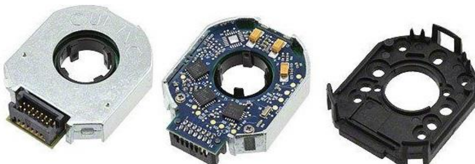
Abb. 3–9: AMT203 Absolutdrehgeber von CUI Inc. [50]
