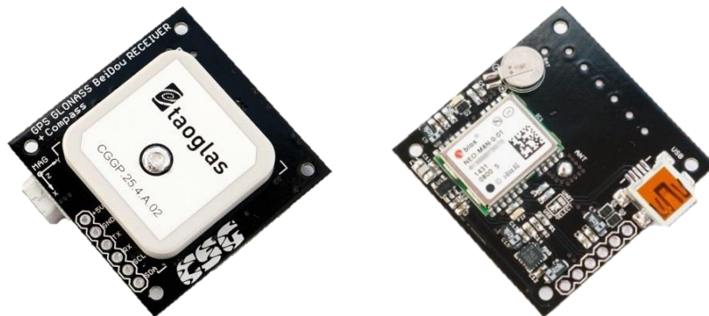
Abb. 3–10: Ublox M8Q Mini GNSS-Empfänger von CSG [52], [53]
