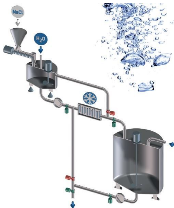
Abbildung 12: Salzsolesystem "daxSol" der Fa. Daxner [20]
