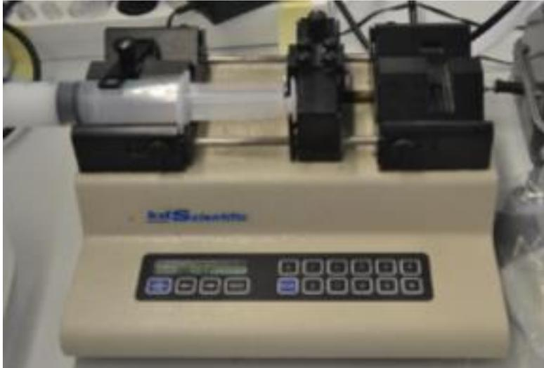
Abbildung 21: Spritzenpumpe mit Blood Mimicking Fluid befüllt. Der Perfusomat pumpt die BMF durch den Silikonschlauch. Dabei sind Schlauchdurchmesser und Durchflussmenge bekannt. Hieraus kann die Durchflussgeschwindigkeit errechnet werden.
