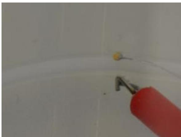
Abbildung 20: Darstellung der an einem Silikonschlauch befestigten Cook-Swartz® Doppler-Sonde. Der Silikonschlauch liegt dabei in deionisiertem Wasser, um eine Kopplung zwischen Messsonde und Silikonschlauch zu ermöglichen.
