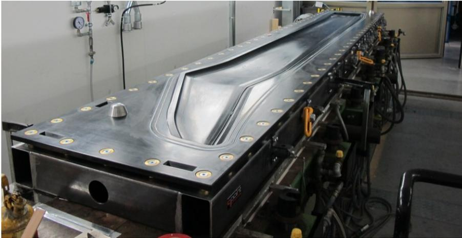
Abb. 2-7: Unterschale eines RTM-Werkzeugs aus CFK zur Herstellung von Demonstrator-Hubschrauberrotorblättern
