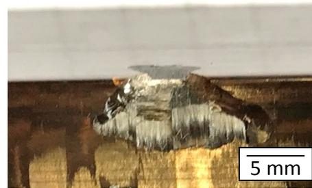
**Abb. 4-7: Kantenversuche mit zylindrischem Prüfstempel**
