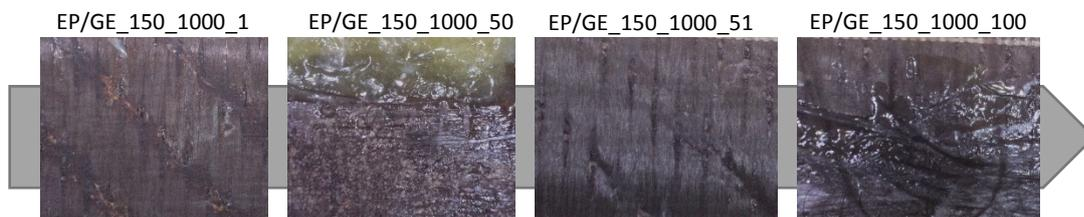
**Abb. A-5:** Versuchsreihe im Werkzeugoberflächenprüfstand mit EP/G-Prüfkörper, thermische Vorbelastung 1000 Zyklen bei 150 °C
