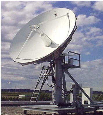
Abb. 4-3: Cassegrain 4,8 m Ka-Band Forschungsantenne des LRT und offizielle Eutelsat Referenzstation
