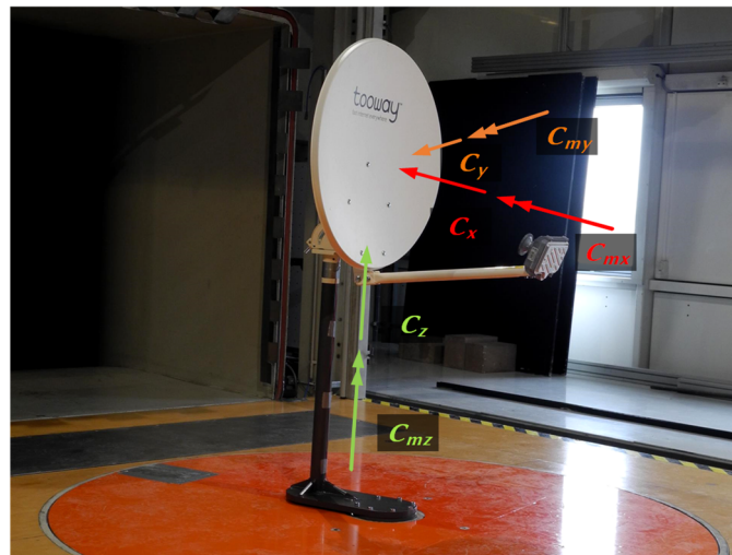
Abb. A - 1: Versuchsaufbau zur Bestimmung der aerodynamischen Widerstandskoeffizienten im Windkanal
