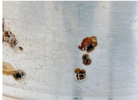
Abbildung 98: Löcher im Rauchgassystem durch Korrosion aufgrund der HCL-Emission.
