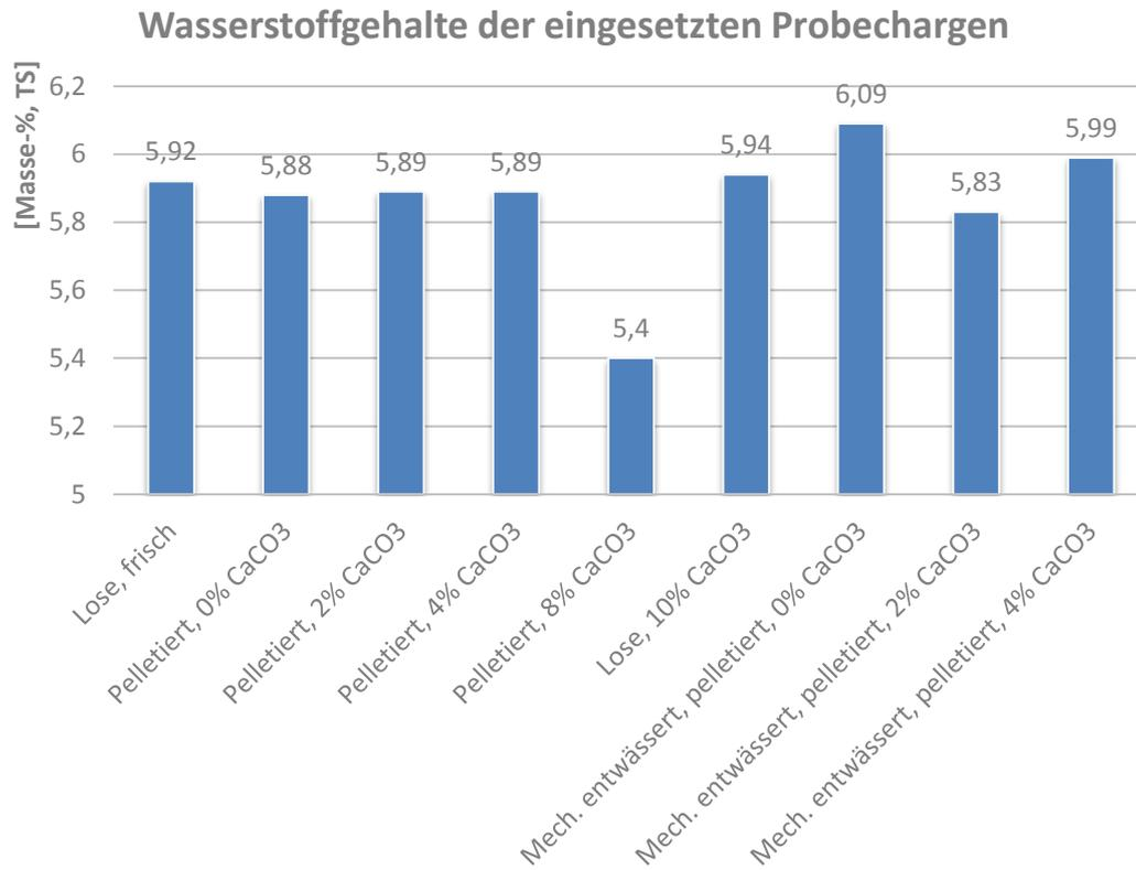
Abbildung 50: Wasserstoffgehalte der der untersuchten Probechargen in Masse-%, atro.
