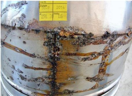
Abbildung 97: Korrosion Rauchgassystem durch HCL-Emission.
