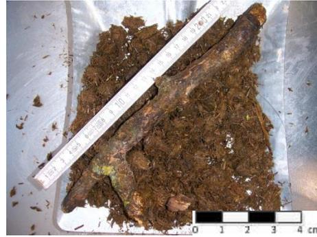
Abbildung 19: Verunreinigung durch einen Ast.
