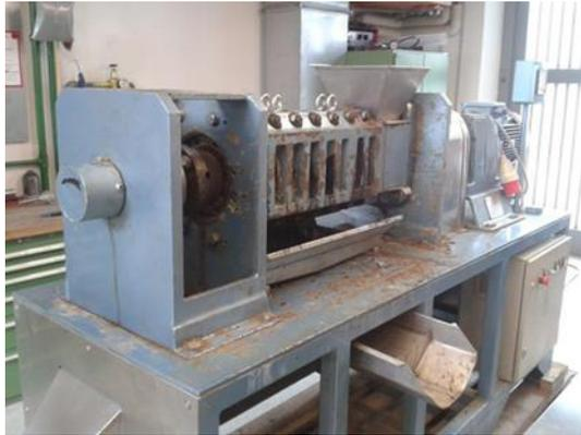
Abbildung 17: Schneckenpresse zur mechanischen Entwässerung des Pferdemists.
