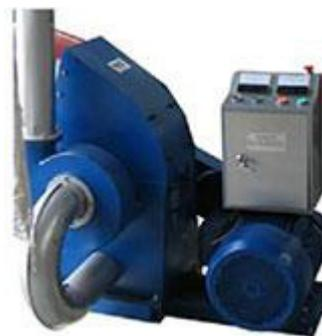
Abbildung 28: Beispiel für den eingesetzten Hammermühlen Typ [78].
