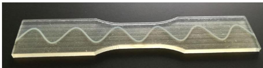
Abb. 7.2 Flexibler Zugstab mit welliger Verstärkungsstruktur hergestellt im PolyJet-Verfahren.
