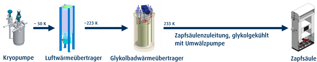
Abbildung 5.2: TMS in der Ausgangssituation [84]
