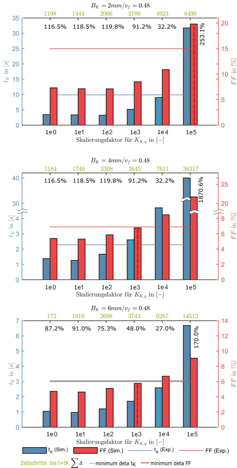
**Abb. 3-20: Vergleich Experiment E2 mit den Ergebnissen der Simulation für den Ansatz 3 für einen FVG von 48%**
