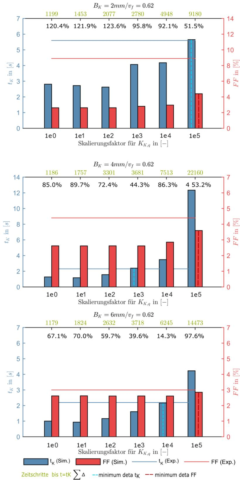
Abb. 3-21: Vergleich Experiment E2 mit den Ergebnissen der Simulation für den Ansatz 3 für einen FVG von 62%
