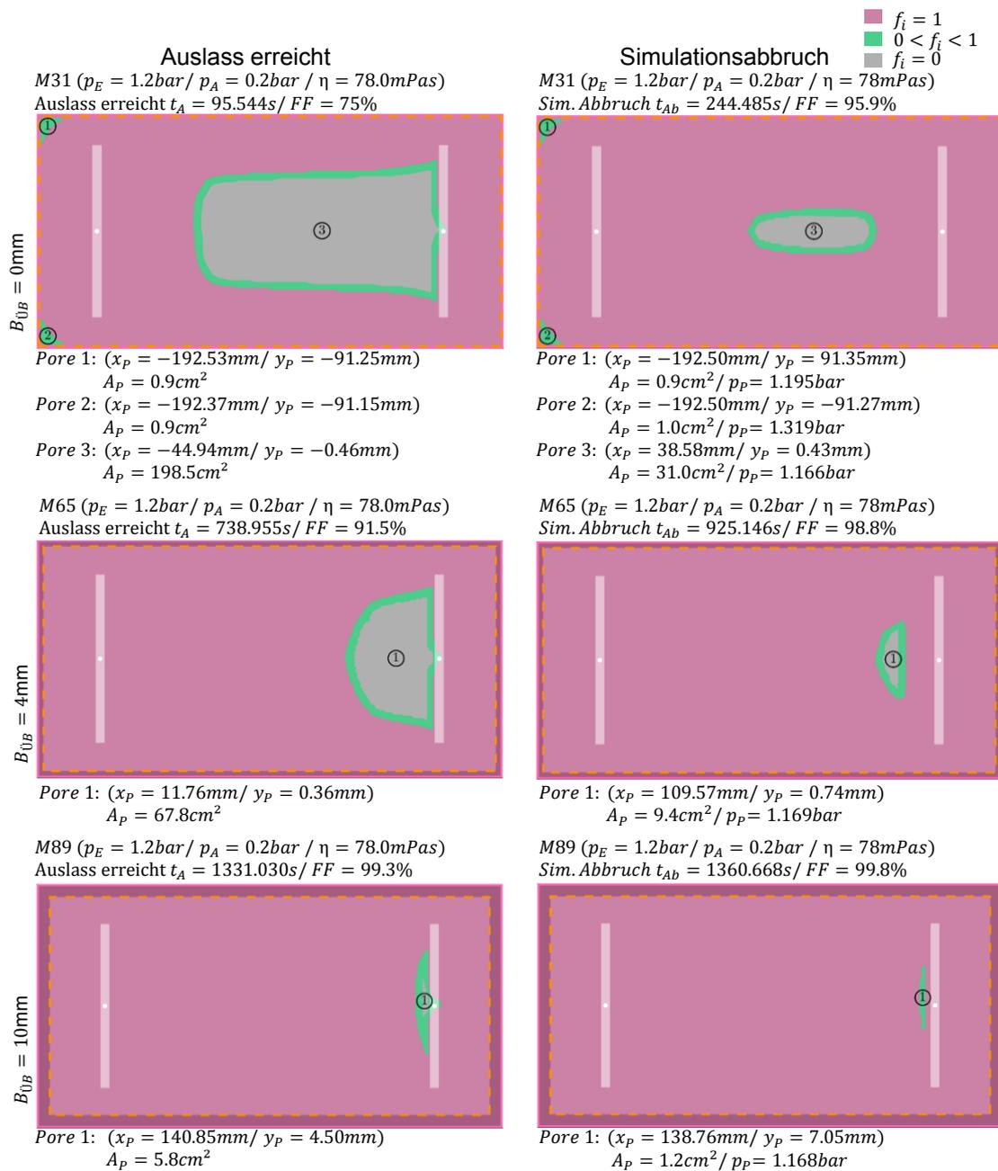
**Abb. 4-19: Position des Linieneinlasses Einlass und Auslasses auf der Preform mit Überpresungsbereich**
