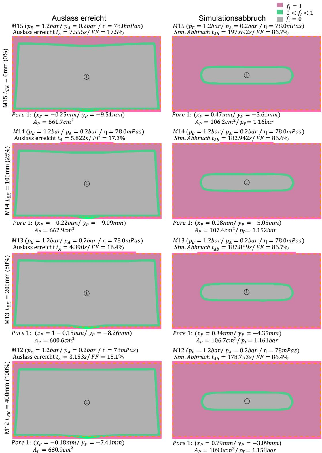
**Abb. 4-9: Position und Dimension des Einlasssystems neben der Preform mit Einlass auf der langen Seite**
