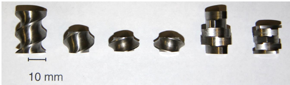
Abb. 3: Modulare Schneckenelemente eines Zweiwellenkneters
