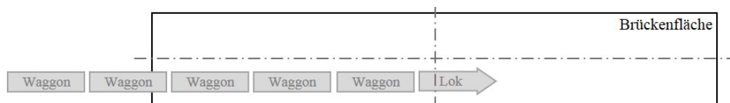
Abbildung 6.2 : Asymmetrische Belastung bei Zugüberfahrt
