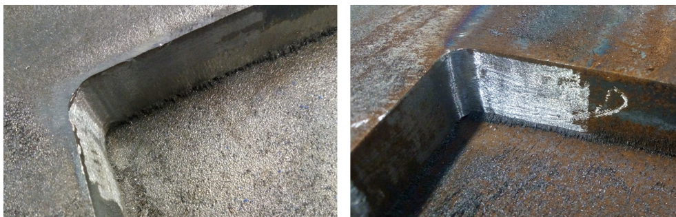
Abbildung 13.15 : Ausschleifen der Brennschnittkanten an den Ausrundungen der Aussparung des Grundblechs mit einem Keramikdremel
