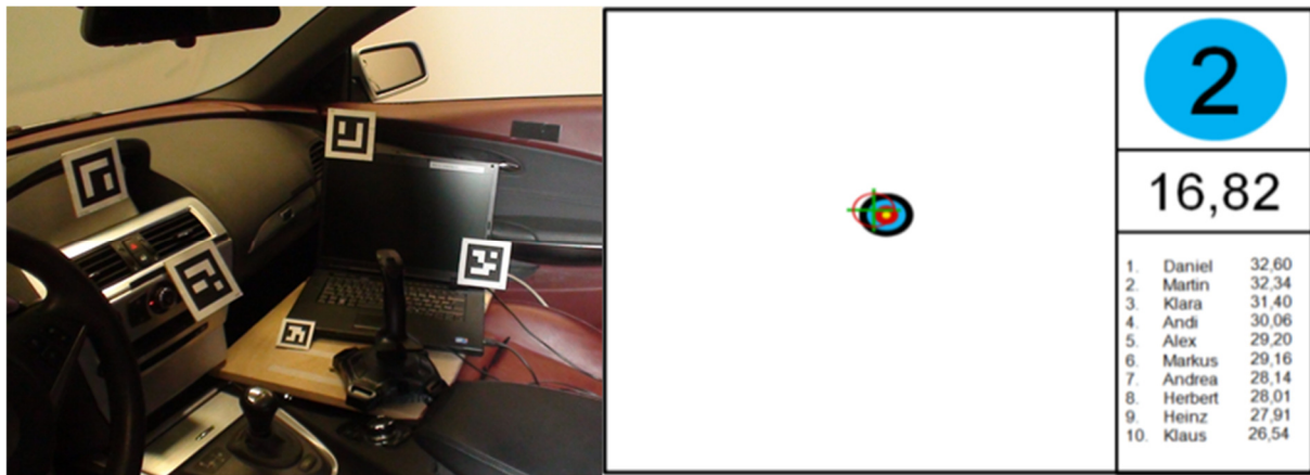
Abbildung 6-5: LINKS – Aufbau von Laptop und Joystick auf dem Beifahrersitz im Fahrzeug; RECHTS – Screenshot der Trackingaufgabe (Damböck et al., 2012a)
