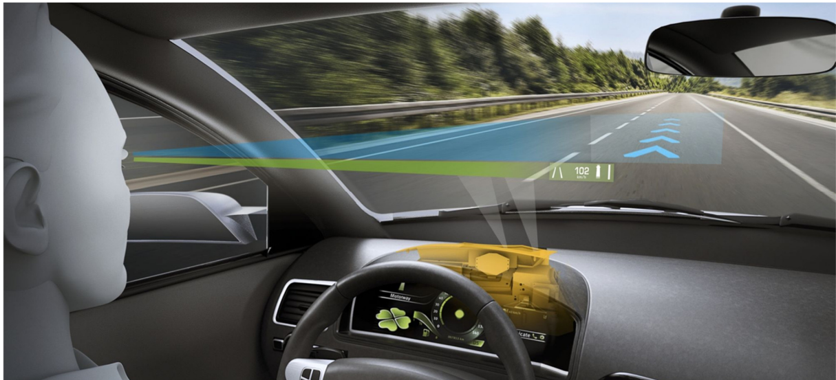
Abbildung 2-4: Statisches oder konventionelles Head-Up Display in Grün und kontaktanalogen Head-Up Display in Blau (Continental AG, 2017).
