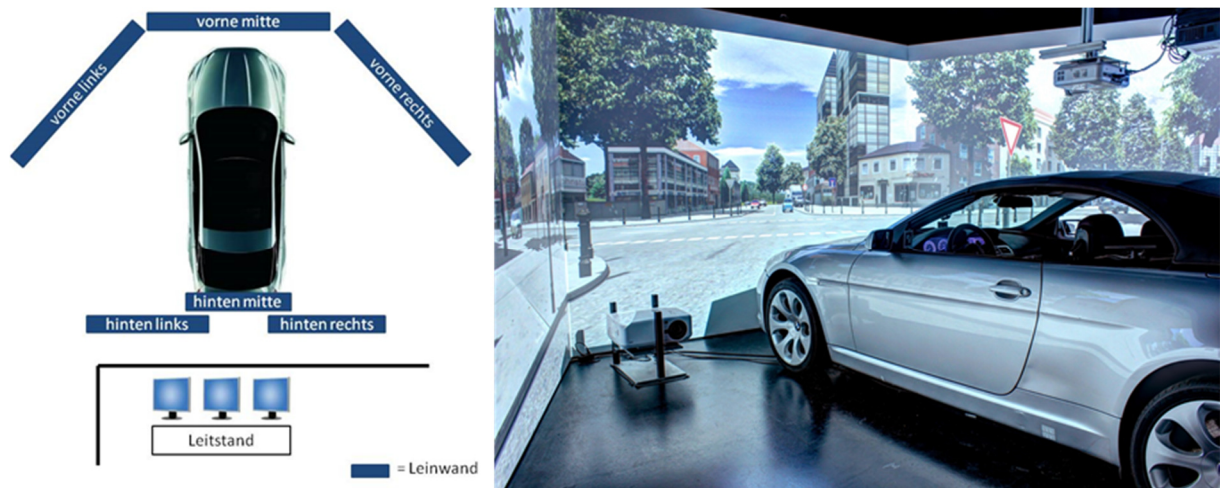
Abbildung 4-1: LINKS – Schematische Draufsicht des Simulators; RECHTS – Außenansicht des Fahrzeugs mit Stadtszenerie (LfE Bilddatenbank).
