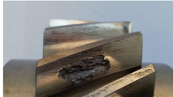
Bild 2.8: Typischer Grübchenschaden an einer Schrägverzahnung
