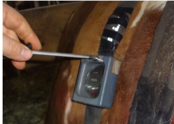
Abb. 34: Schutzkästchen mit darüber liegendem Wearlink und Übergurt
