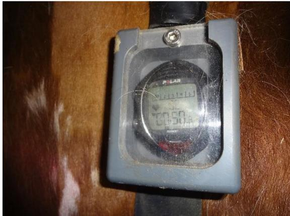
Abb. 33: Herzfrequenzmessgerät Polar RS800CX im Schutzkästchen
