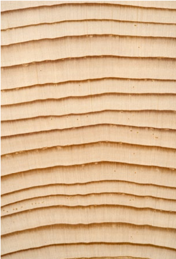
Abbildung 4: Fichte, Querschnitt (Lupenbild) Foto: Holzforschung München
