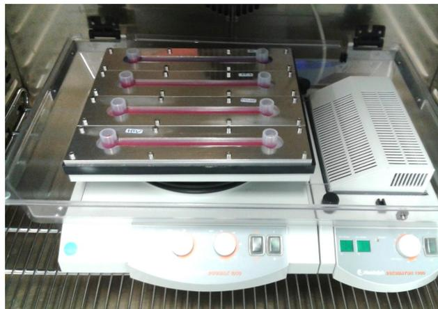
Abb. 3.8: **Inkubation von Thrombozytenkonzentrat.** Der Plattformschüttler trägt gleichzeitig 4 Referenzproben und wird in ein Wärmeschrank gestellt, um die Umgebungstemperatur bei  $37^\circ\text{C}$  konstant zu halten.
