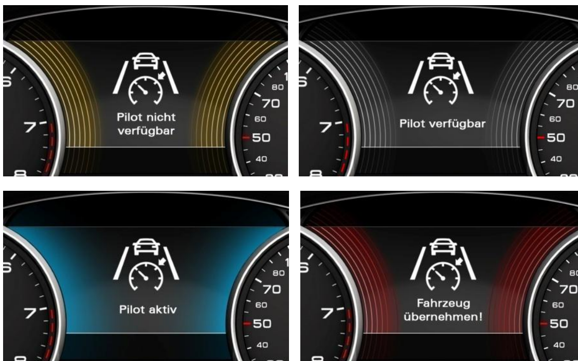
Abbildung A-2: Systemzustände im Kombidisplay
