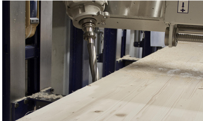
Abbildung 15: 5-achsige CNC-gesteuerte Abbundanlage Lignamatic. Bild: Archiv Krüsi Maschinenbau AG.
