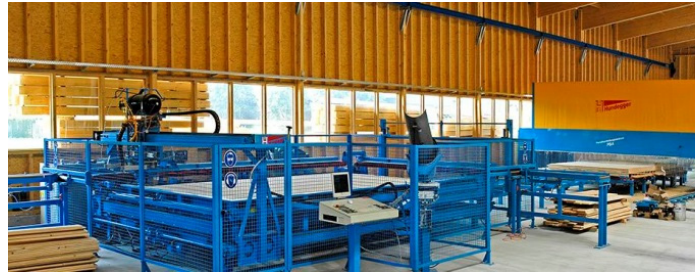
Abbildung 11: Fertigungslinie für Massiv-Holz-Wandelemente zur kreuzlagigen Verpressung. Die weitere Verarbeitung erfolgt dann bspw. in Portalbearbeitungsanlagen. Bild: Hans Hundegger AG.
