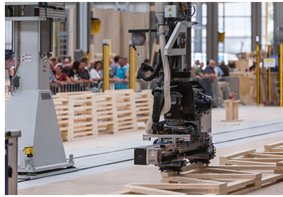
Abbildung 13: Portalroboter. Bild: Erne AG Holzbau, Laufenburg.
