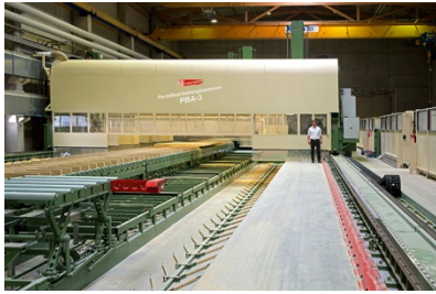
Abbildung 10: Portalbearbeitungszentrum Hundegger PBA-3. Bild: Hans Hundegger AG.
