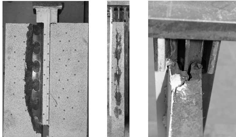
Abbildung 5.16: Push-Out Körper mit Spaltversagen nach Versuchsende in der Ansicht (links), mit einem Sägeschnitt durch den UHPC entlang der Verbunddübelreihe (Mitte) und in der Seitenansicht von oben (rechts)
