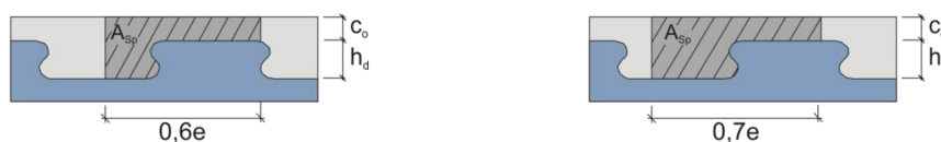
Abbildung 5.20: Größe der durch Spaltzugspannungen belasteten Betonfläche beim Modell nach [Eur93] (links) und [Leo86] (rechts) [Hei11]
