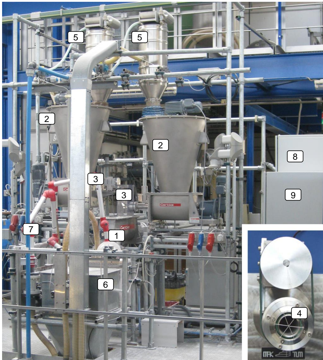
Abbildung 4.13: Versuchsanlage zum kontinuierlichen Feststoffmischen
