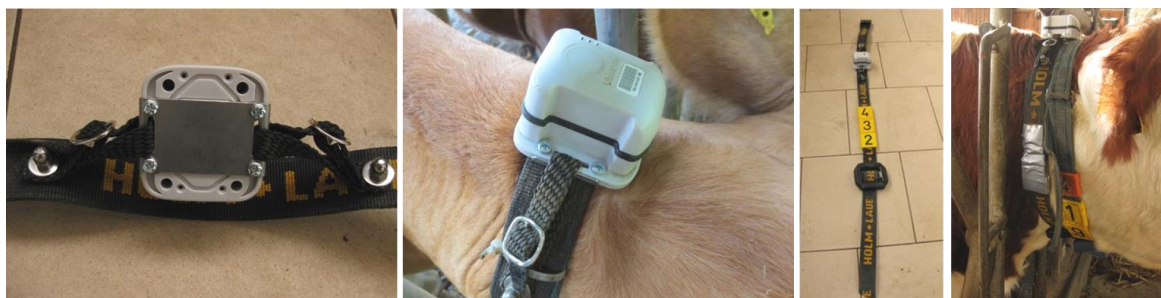
Abbildung 21: Metallplatte am Transponder, Befestigung mit Sporenriemchen am Halsband, dorsale Positionierung des Transponders über Tauchergewicht und Befestigung des Verschlusses über Panzertape
