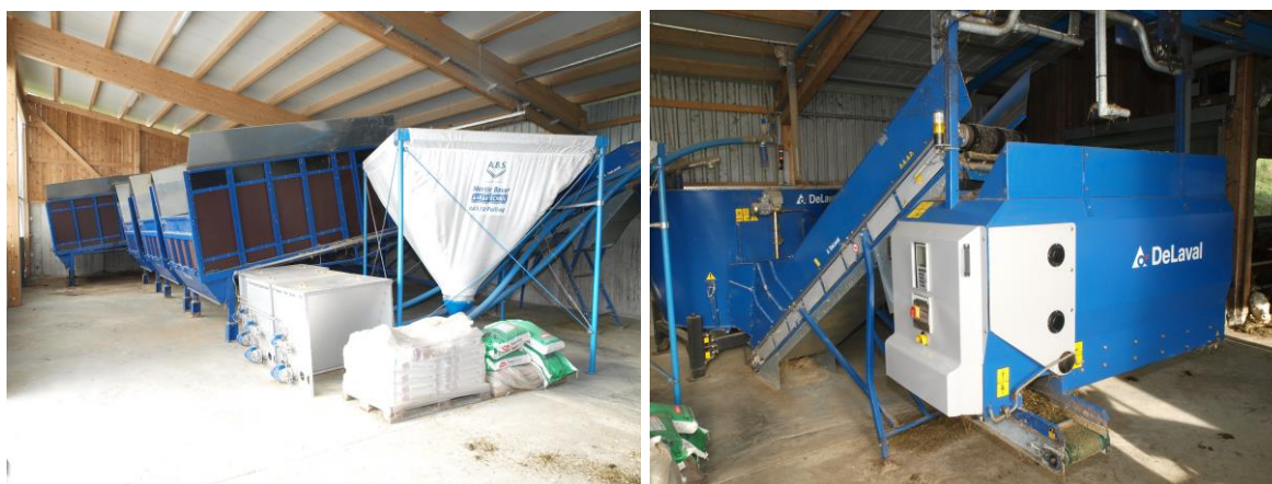
Abbildung 14: Vorratsbehälter, Mineralstoffdosierer, Krafftuttersilo und Futterverteilwagen beim Futterdosieren am stationären Mischer
