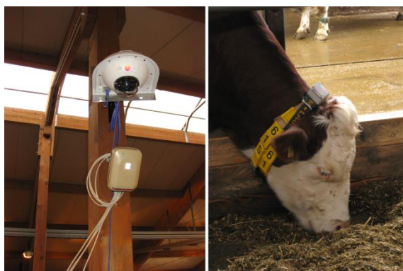
Abbildung 11: Im Stall montierte Kamera und darunter angebrachter Ubisense Series 7000 Sensor, Kuh mit Halsband und befestigtem Transponder einschließlich Kunststoffgehäuse (OBERSCHÄTZL-KOPP et al., 2016a)
