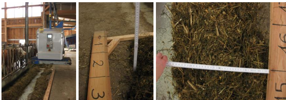
Abbildung 17: Ermittlung der Ausprägung des Futterschwads im Trog und des weggeschobenen Futterrests mit Hilfe einer Messlatte
