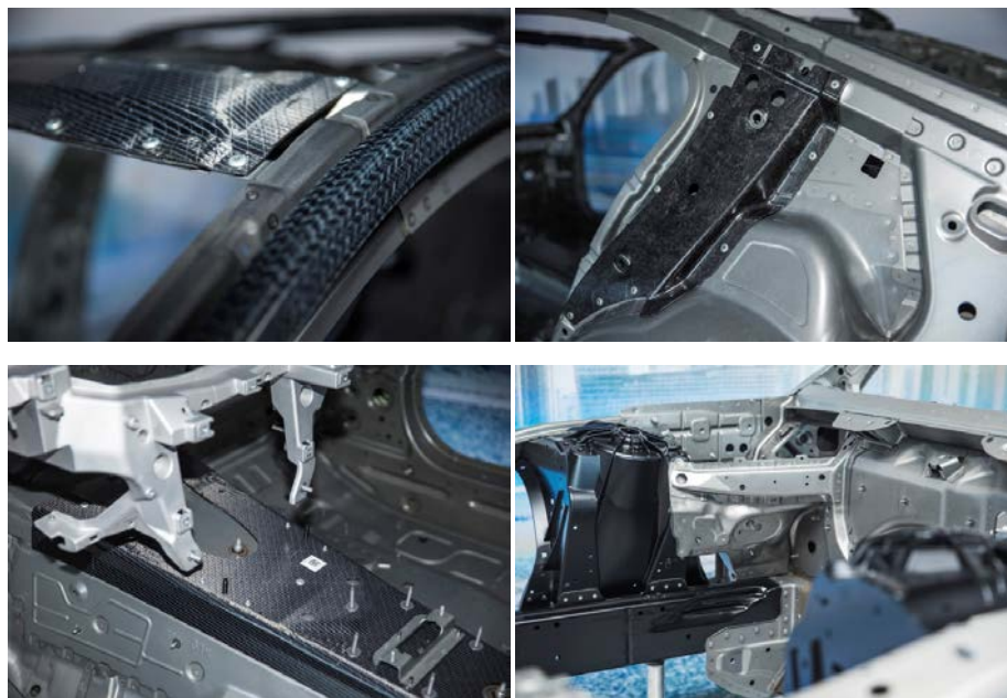
Abb. 3-33: BMW 7er Efficient Lightweight mit Carbon Core Hybrid-Bauweise – Integration von CFK und Aluminium-Bauteilen [30]
