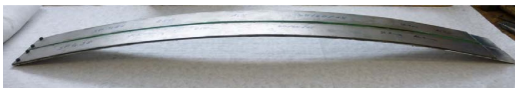
Abb. 10-11: Experiment zur Bestimmung der Verformung einer Stahl-Aluminium Mischbauklebung
