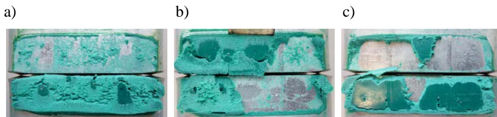
Abb. 7-31: Bruchbilder Schubversuch bei 70 °C nach 50 % Gleitungsbeanspruchung mit zunehmend adhäsivem Anteil a) Klebstoff E4a, b) Klebstoff E5b und c) Klebstoff E5a
