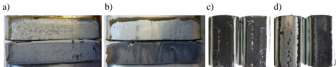
Abb. 7-3: Bruchbilder a) kohäsiv T < T_G - 70 °C Schub, b) adhäsiv T > T_G - 130 °C Schub c) kohäsiv T < T_G - 70 °C Zug, d) adhäsiv T > T_G - 130 °C Zug
