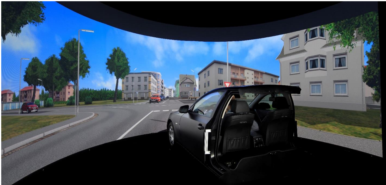
Abbildung 7 Der statische Fahrsimulator 2 im BMW FIZ.
