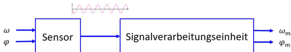
**Abbildung 8.1:** Struktureller Aufbau eines einkanaligen Drehzahlgeberprodukts, bestehend aus Sensor und Signalverarbeitungseinheit.
