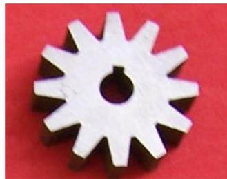
**Abbildung 6.9:** Verwendeter Zahnrad mit zwölf Zähnen. Es liefert zwölf Signalperioden pro Umdrehung und kann durch seine Form ein besseres sinusförmiges Ausgangssignal erzeugen.
