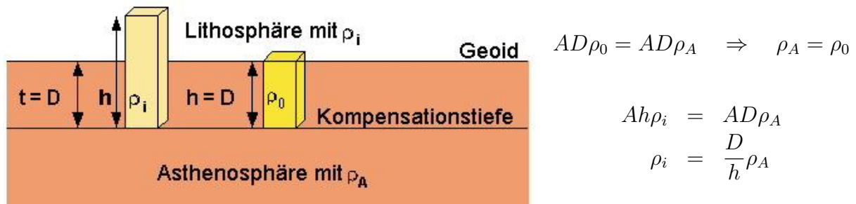
Abb. 2.4: Schwimmgleichgewicht des Pratt-Hayford-Modells
