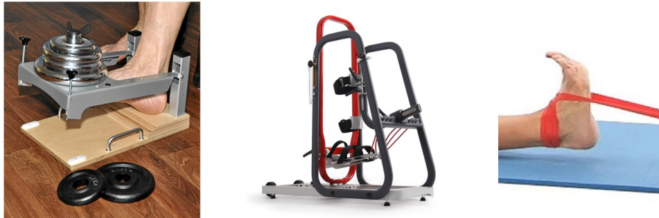
Abbildung 2.4.: Passive mechanische Geräte zum Trainieren der dorsalen Flexoren. Links: [siehe Ginten, 2015], Mitte: [siehe Terma, 2015], Rechts: [siehe Sportsinjuryclinic, 2015].
