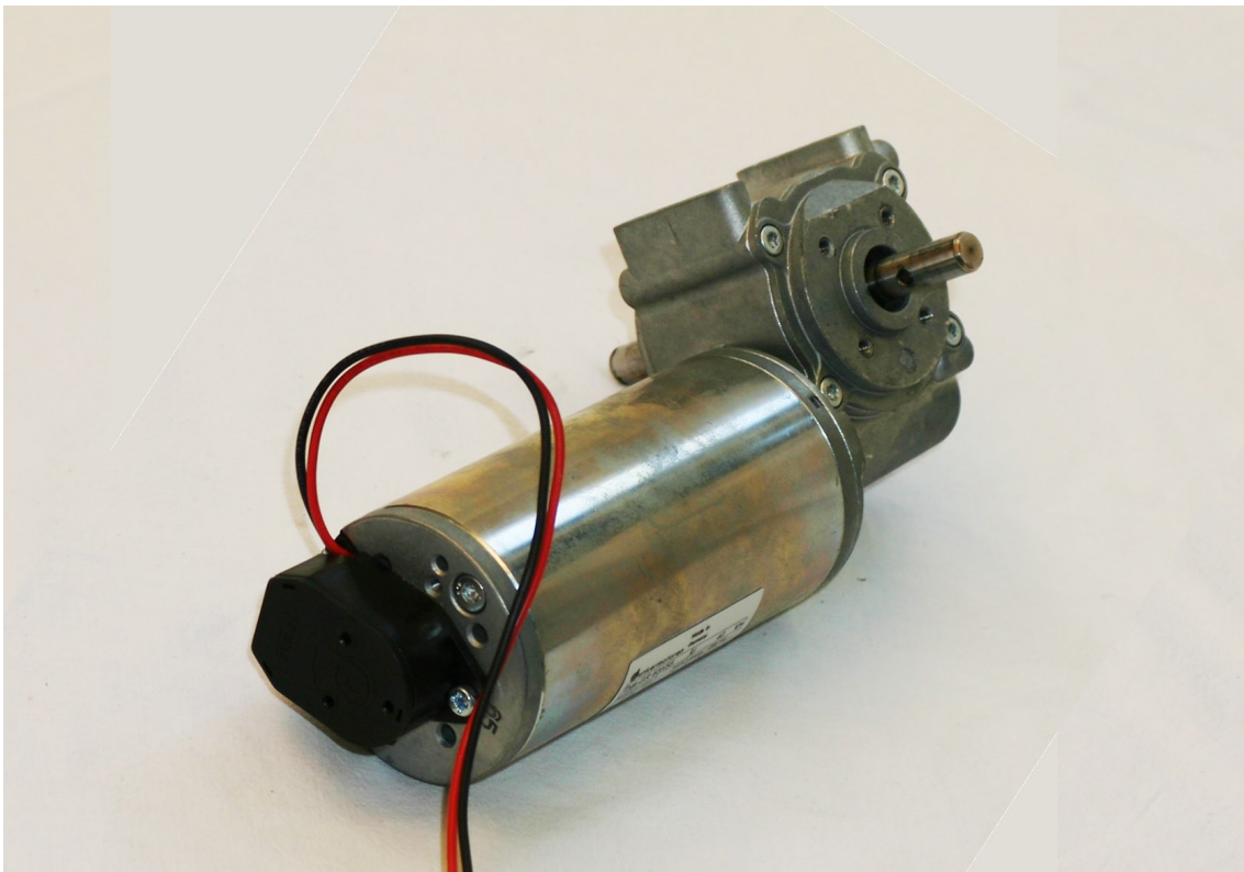
Abbildung 5.3.: Motor Typ GR63x55, 3450 U/min, 100W [vgl. Dunkermotoren GmbH, 2015a] mit angeflanschem Schneckengetriebe Typ SG80, Untersetzung 24,5:1 [vgl. Dunkermotoren GmbH, 2015c] sowie Drehgeber Typ RE30-2 [vgl. Dunkermotoren GmbH, 2015b] der Dunkermotoren GmbH .
