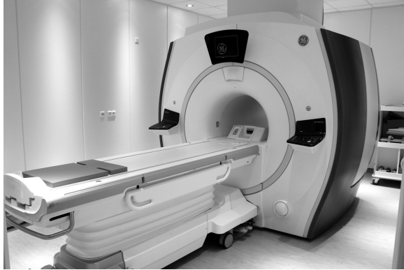
Abbildung 4.3: Im 3-Tesla-Grundfeld dieses Human-MRTs wurden die Partikel einer Probe magnetisch ausgerichtet.
