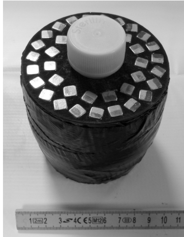
Abbildung 4.5: Dieser Halbach-Zylinder wurde entsprechend der Simulation zweireihig gefertigt. Auf den Magneten ist jeweils die Magnetisierungsrichtung markiert.
