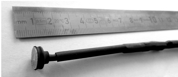
Abbildung 4.1: Diese Pick-up-Spule wurde gebaut, um Magnetfelder messen zu können.
