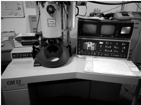
Abbildung 4.2: Zu sehen ist das verwendete TEM mit dem Mikroskopiezylinder links und der Kontroll und Ausgabeeinheit rechts im Bild.
