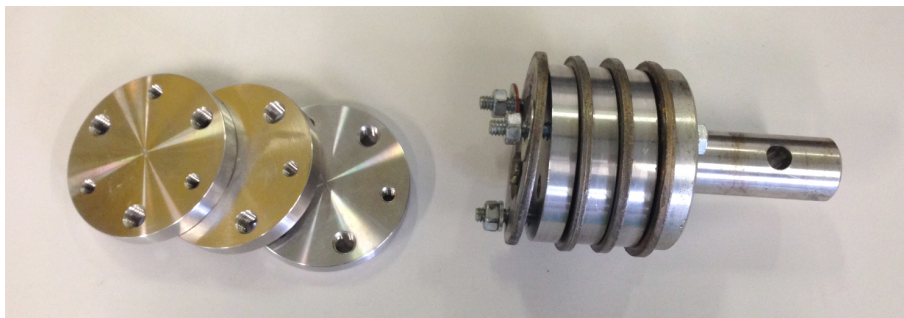
Abb. 3.24: Zur Herstellung der NOL-Ringe verwendetes Wickeldorn mit Einzelkavitäten. (Quelle: Optimum Composite Technologies LLC, USA).
