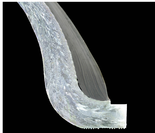
(b) Aufdickungen am Ende der Helical-Lagen.
