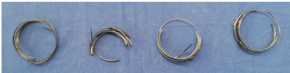
(c) Zerstörte NOL-Ringe nach der Prüfung.
