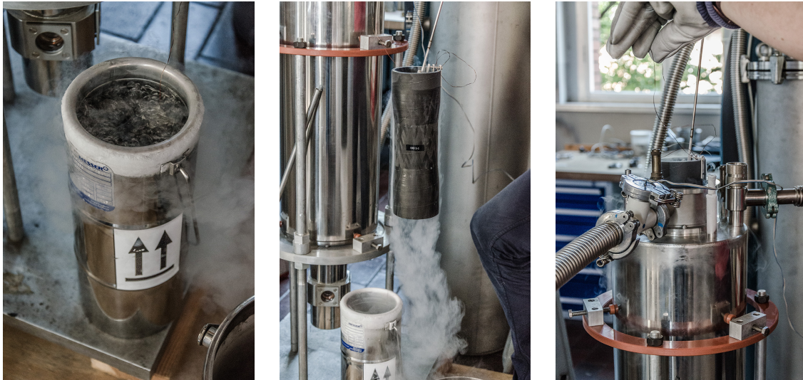
(a) Probekörper im Liquid Nitrogen (LN 2 )-Bad als Zwischenschritt im Kühlprozess.
