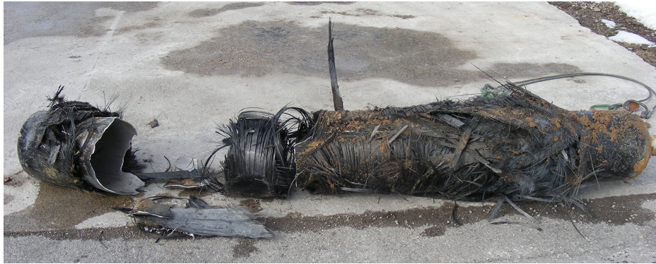
Abb. 1.5: Im kontrollierten Berstversuch unter hydraulischem Druck bei rund 4 \times \text{MOP} willentlich gebrochener Typ 3-Druckbehälter.
