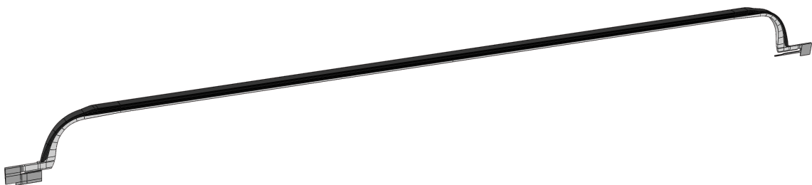
Abb. 4.22: Screenshot des gesamten 1/45-FE-Modells des Typ 3-Druckbehälters.
