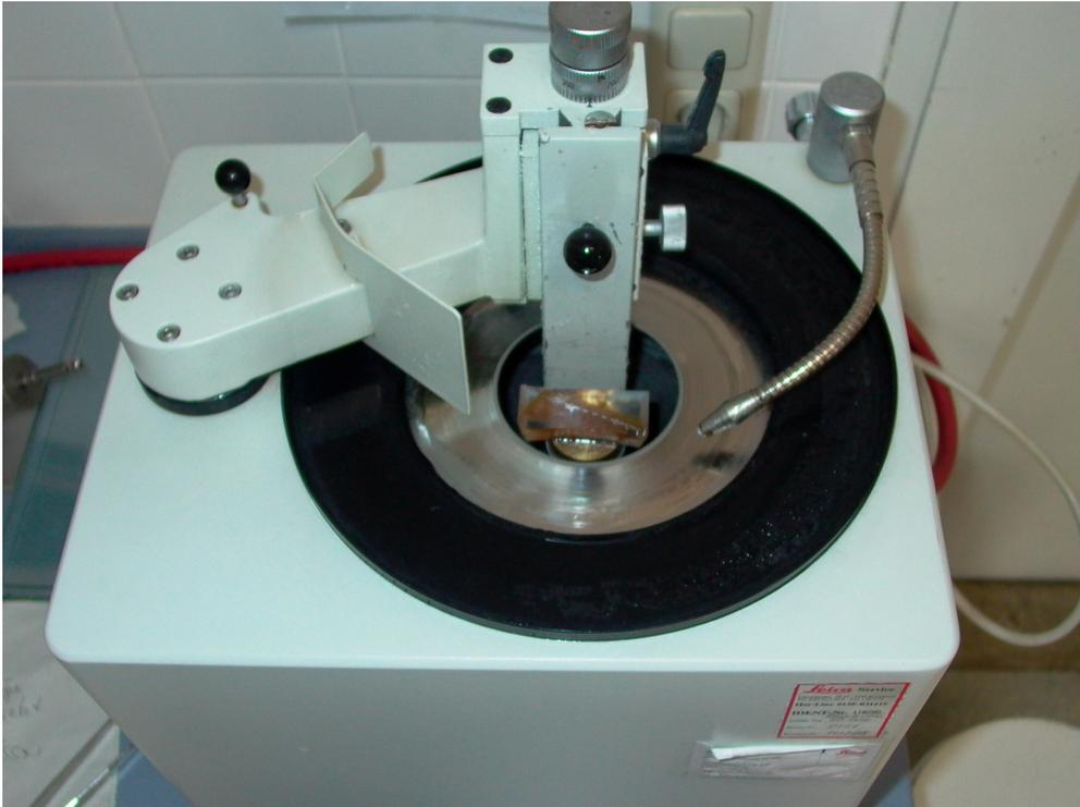
Abbildung 19: Innenlochsäge mit Diamantsägeblatt (Sp1600 der Firma Leica Biosystems)
