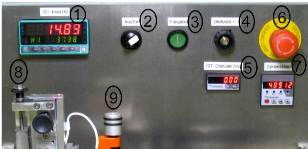
Abbildung 12: Bedienung des Reibprüfstands; 1) Kraftmessung, 2) Aus/Ein, 3) Start/Stopp, 4) Soll-Drehzahl, 5) Ist-Drehzahl, 6) Not-Aus, 7) Zyklenzähler, 8) Federspannrädchen, 9) Exzentereinstellung
