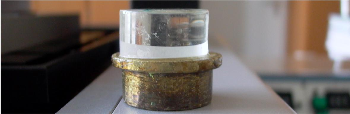
Abbildung 18: ausgehärteter MMA-Block ohne Präparat, auf Messingblock aufgeklebt
