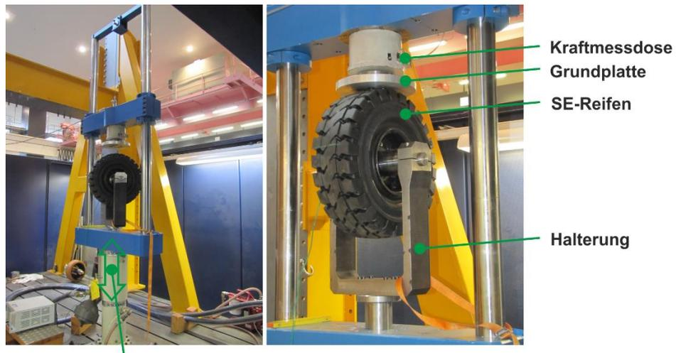
Hydropulserlängszylinder - Vertikale Bewegung
