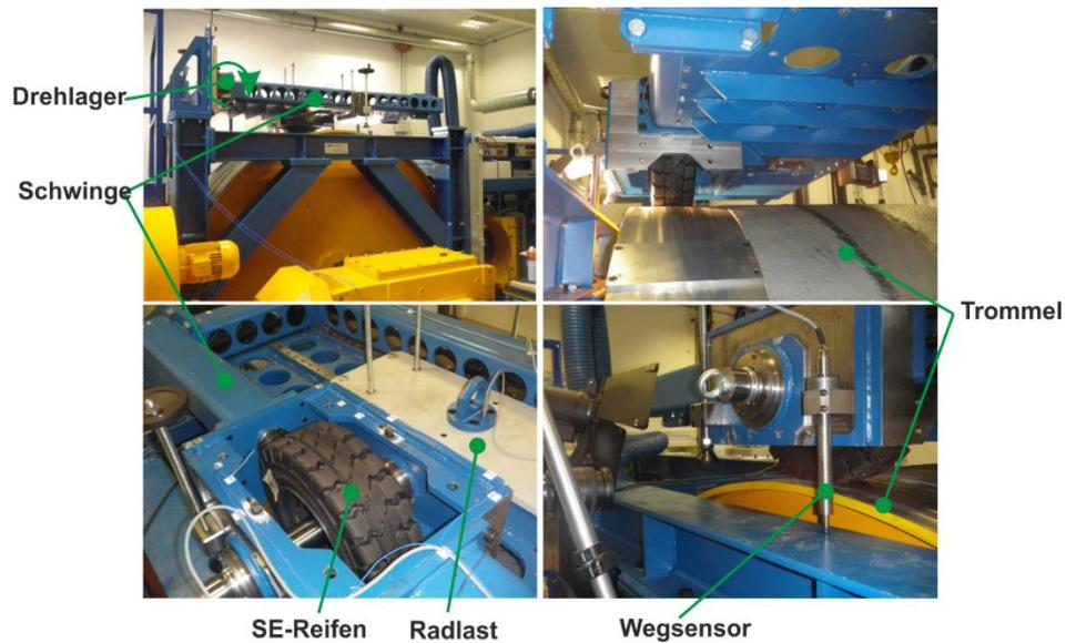
Abbildung 6-2: Trommelprüfstand
