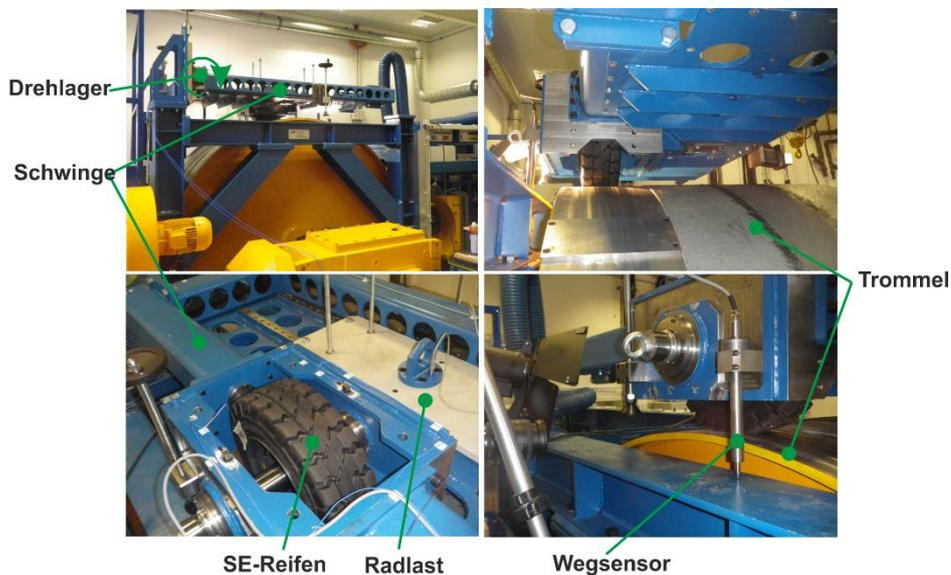
Abbildung 7-7: Trommelprüfstand in Realität
