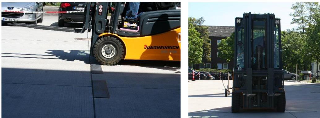
Abbildung 6-7: a) Ein Rad fährt über die Schwelle, b) Beide Räder fahren über die Schwelle
