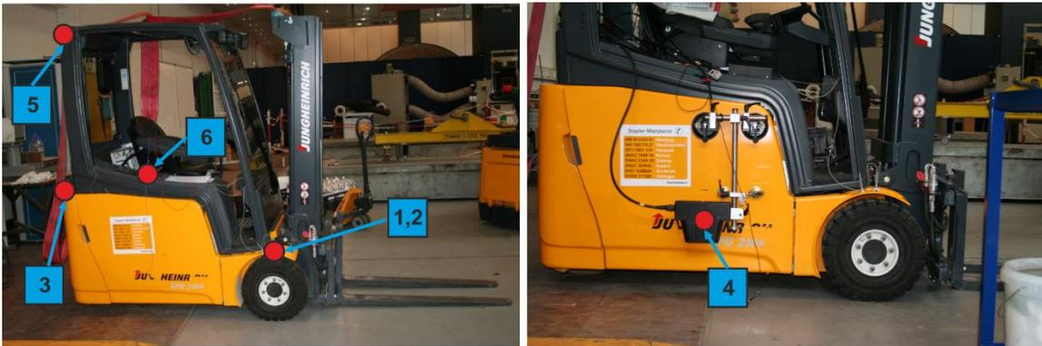
Abbildung 6-6: Referenzfahrzeug mit den Beschleunigungssensoren auf der Radachse (1 und 2), am Lenkbock (3), in der Fahrrichtung am Dach (5) sowie rechts neben dem Sitz (6)
