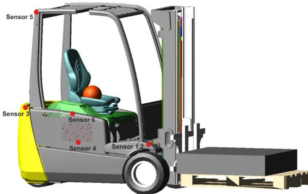
Abbildung 7-31: Sensoraufbau am Gesamtfahrzeugmodell
