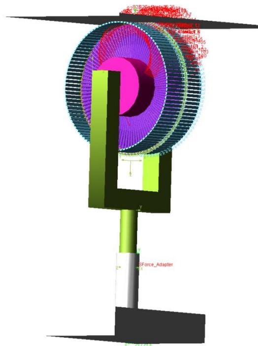
Abbildung 7-2: Virtueller Hydropulserprüfstand mit dem mechanischen SE-Reifenmodell in ADAMS/View
