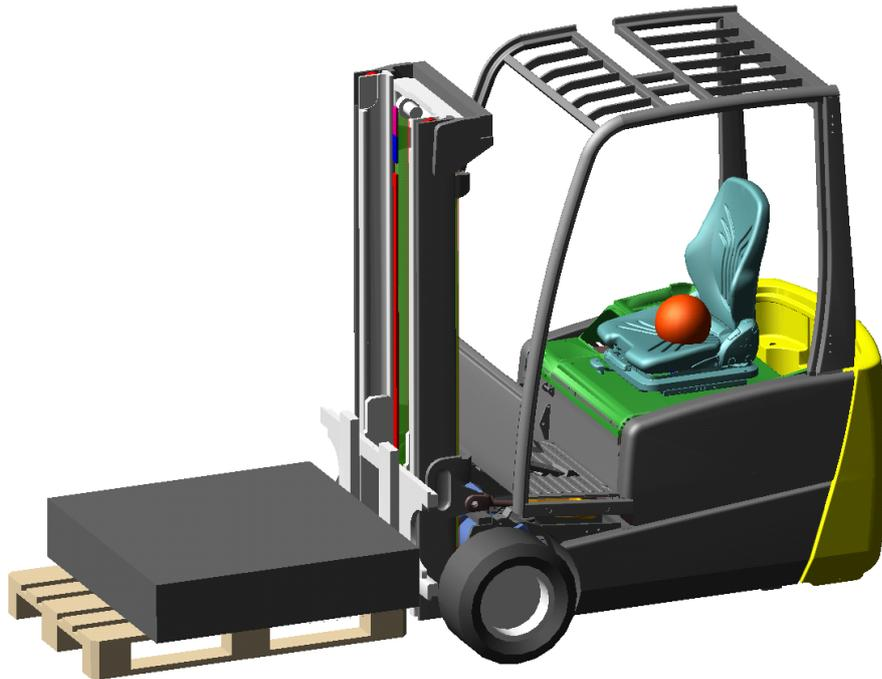
Abbildung 7-30: Mehrkörpermodell des Gegengewichtsgabelstaplers EFG216k
