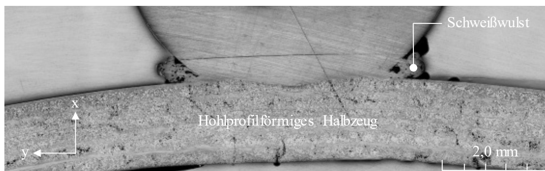
Abb. 6-17: Schliffbild der Schweißverbindung PA6-GF \pm 45^\circ /PA6
