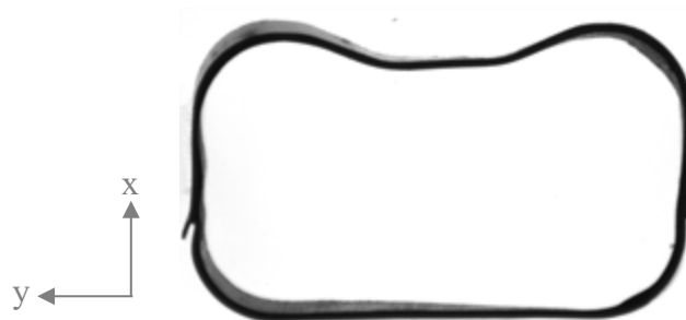
Abb. 5-43: Schnittbild des Hohlprofilbauteils WZ 25.5 (PA6-GF \pm 75^\circ )
