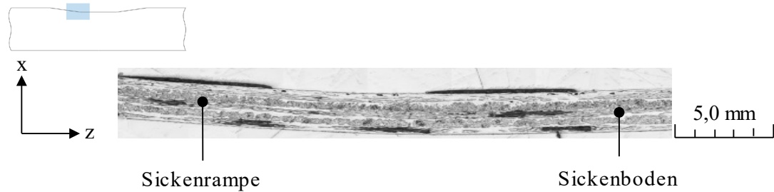
Abb. 5-45: Schliffbild des Hohlprofilbauteils WZ 25.5 (PA6-GF \pm 45^\circ , Sicke) T_{WZ} = 120 \text{ }^\circ\text{C} , p_u = 50 \text{ bar} .
