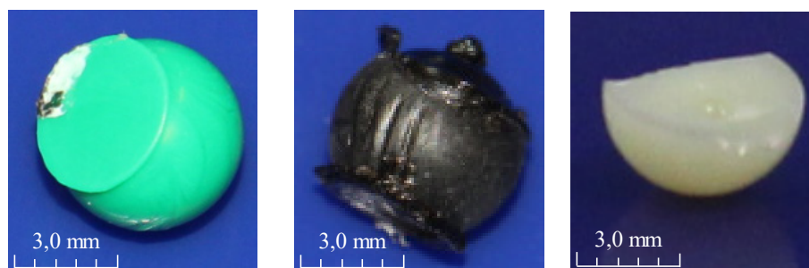
Abb. 6-3: Fehlschweißungen bei Variation der Prozessparameter [138]
