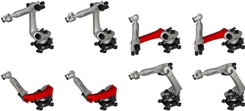
*Abbildung 6.5: Für jede Lage des Endeffektors existieren bei Vertikal-Knickarmrobotern acht Lösungen. Rot markierte Gelenkstellungen sind aufgrund mechanischer Begrenzungen nicht erreichbar.*
