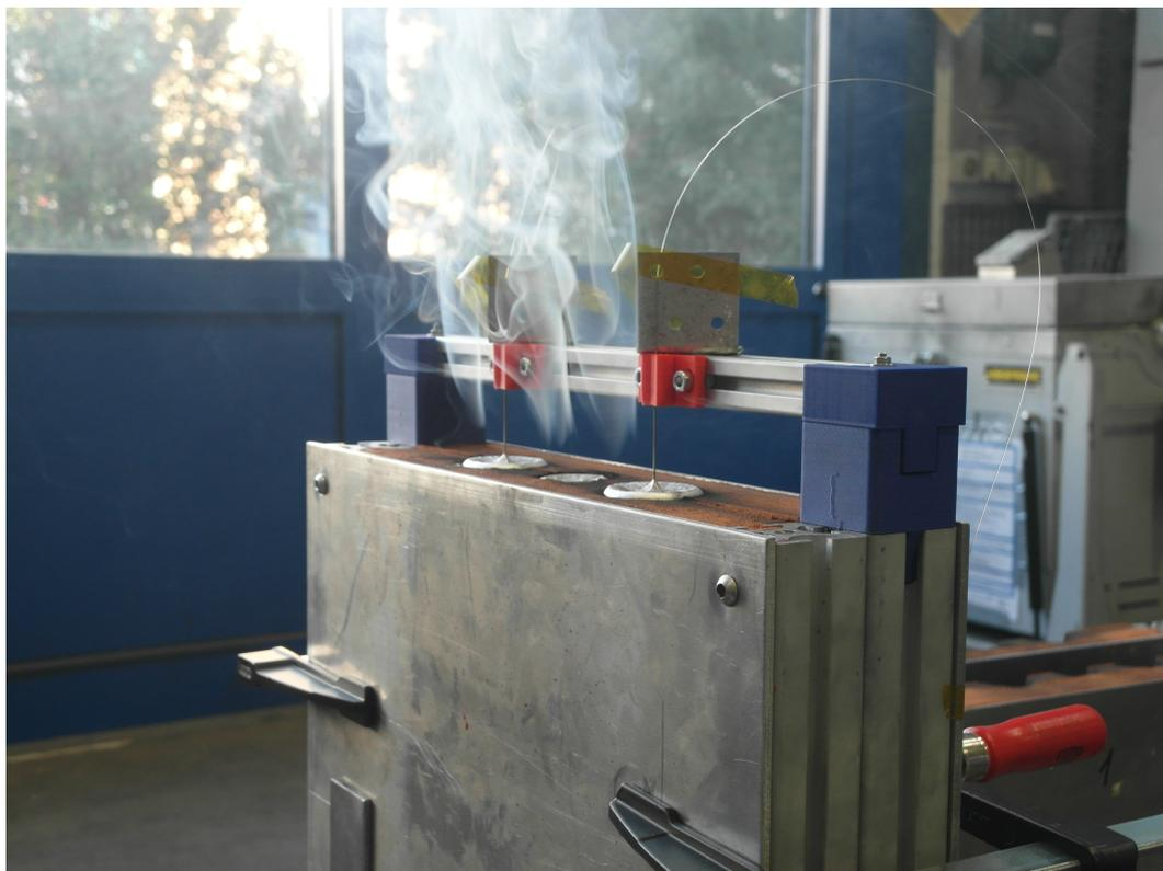
Abbildung 3.3: Komplettierte Gussform kurz nach dem Abguss.
