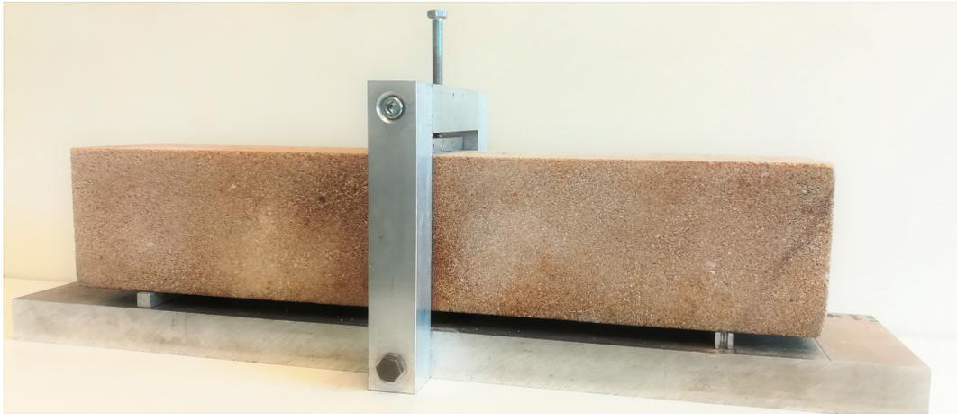
Abbildung 3.16: Aufbau zur mechanischen Belastung der Sandsteine. Die Sensorik ist auf der Unterseite der Probe befestigt und in Abbildung 3.17 schematisch dargestellt.
