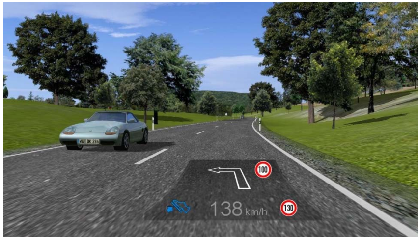
Abbildung 5-9: HMI des vorausschauenden Fahrerassistenzsystems im HUD (in der Abbildung, Anzeige nicht übereinstimmend mit der Verkehrssituation; aus Wu, 2013)
