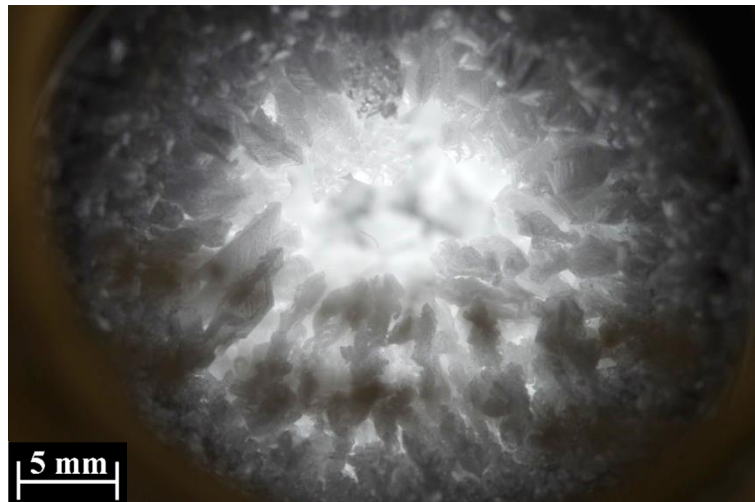
Abbildung 5.38: Aufnahme der Kristallbildung am Anschweißflansch der Schauglaseinheit nach einer Versuchszeit von ca. 10 Stunden mit 60 Vol.-% CH 4 und 40 Vol.-% CO 2 bei einem Gesamtvolumenstrom von 581 ml/min
