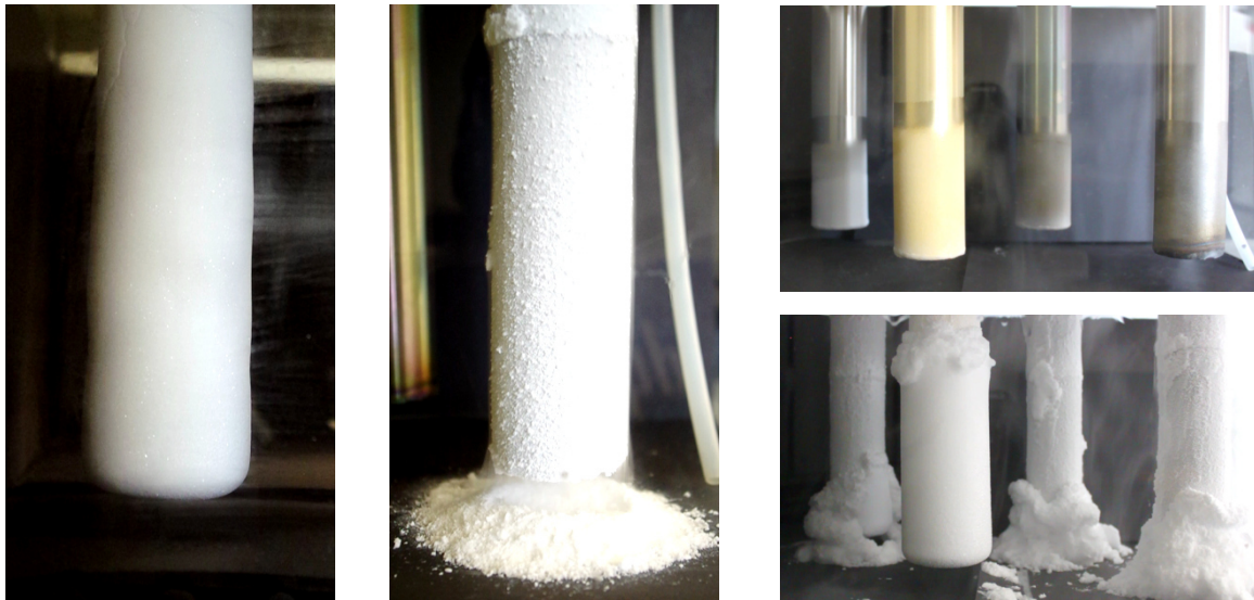
Abbildung 5.4 links und Mitte: Bildung fester Trockeneisschicht bei einem Volumenstrom von 15 000 ml/min bzw. einer locker anhaftenden Reifschicht bei einem Volumenstrom von 4000 ml/min (Ober 2016). Rechts: Untersuchung der Effekte manueller Kraftimpulse und Oberflächenenergie verschiedener Wärmeübertragerproben bei t = 0 min und t = 30 min. Deutlich zu erkennen ist die feste Eisschicht auf der Goldprobe (zweite von links).
