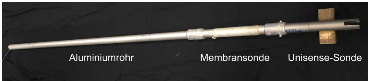
Abbildung 50: Messaufbau zur Messung von gelöstem N_2O in der Kläranlage.
