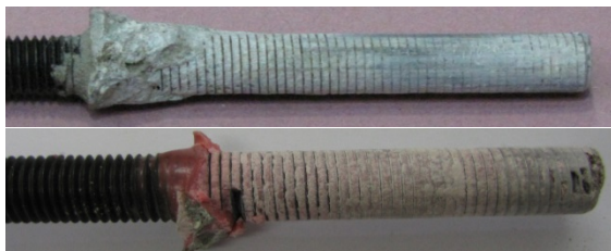
Bild 6-6: Verbundversagen von Verbunddübeln (oben VE, unten EP) in der Grenzfläche Ankerstange/Verbundmörtel
