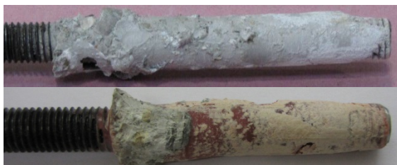
Bild 6-7: Verbundversagen von Verbunddübeln (oben VE, unten EP) in der Grenzfläche Verbundmörtel/Beton
