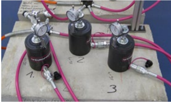
Bild 5-22: Hydraulisch gesteuerte Hohlkolbenzylinder für die Dauerstandversuche zum Kurzzeitkriechen, hier exemplarisch am Verbunddübel VE
