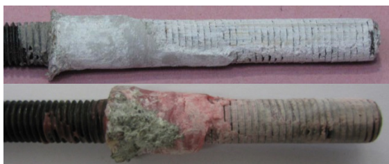
Bild 6-8: Verbundmischversagen von Verbunddübeln (oben VE, unten EP)
