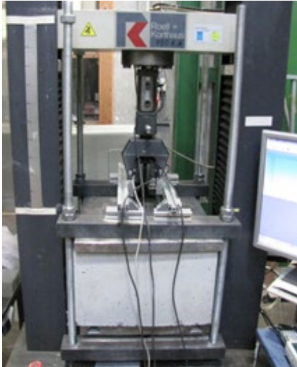
Bild 5-42: Druck-/Zug-Prüfgerät für die Degradationsversuche
