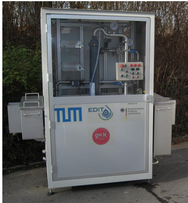
Abbildung 11: Foto der Ultrafiltrationsanlage Konti-CUF mit Vorrattank (rechts) und Filtrattank (links).
