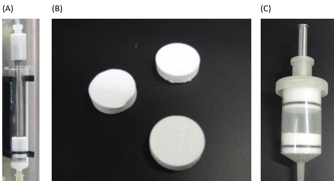
Abbildung 9: MAF Glassäule (A), MAF-Disks (B) und MAF-Säule (C)
