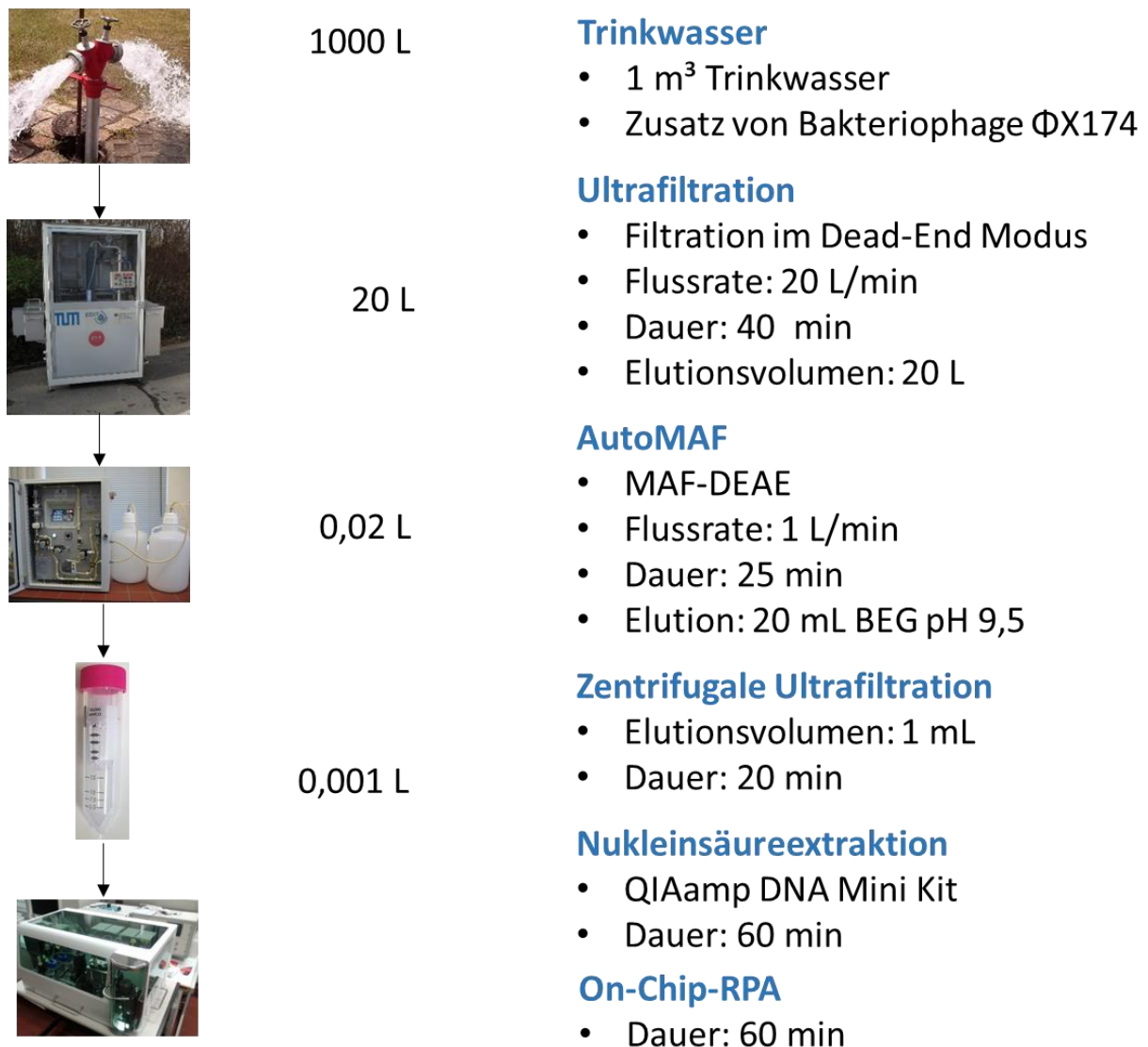
Abbildung 31: Schematische Darstellung des experimentellen Ablaufs zum Test des Verbundverfahrens aus Ultrafiltration, monolithischer Adsorptionsfiltration, zentrifugaler Ultrafiltration zur Aufkonzentrierung, Nukleinsäureextraktion und On-Chip-RPA zur Detektion von Pathogenen in Wasser.
