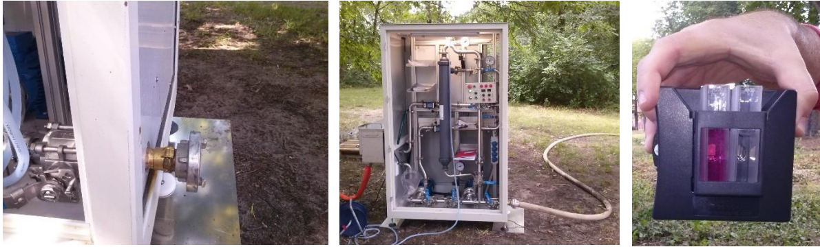
Abbildung 35: Adapter zum Anschluss des Druckschlauches an die Rohrleitung (links). Anschluss der UF-Anlage an die Teststrecke im Wasserwerk Berlin-Friedrichshagen ohne Probenbank (Mitte). Nachweis von Chlor in der Teststrecke mittels Farbreaktion und Vergleichsküvette (rechts).
