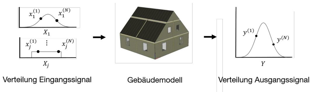
**Abbildung 15.1:** Erstellung der Datengrundlage auf Basis des Ein- und Ausgangssignals des Gebäudemodells mit Hilfe einer Monte-Carlo-Simulation
